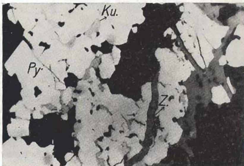
Abb. 17. Durchbewegter Pyrit (weiss), der an Spältchen und Brüchen durch Kupferkies (hellgrau) und Zinkblende (grau) verheilt wird. Dunklere Stellen Sideroplesit. Polierter Anschliff II Nicols. Natürliche Grösse (0,116 mm).
