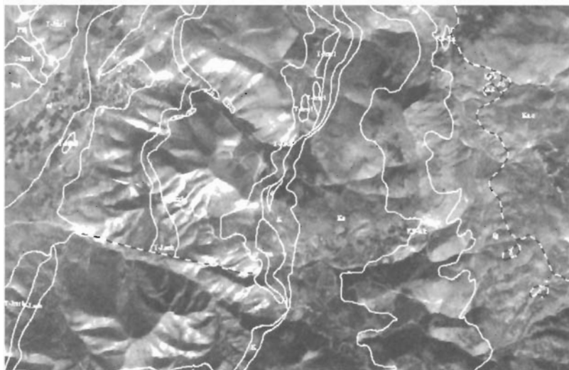
ΣΧΗΜΑ 2. Παγχρωματική εικόνα του SPOT δορυφορικού συστήματος με σχεδιασμό των ορίων των γεωλογικών σχηματισμών (άσπρες γραμμές) και τεκτονικών στοιχείων (διακεκομμένες γραμμές) του 1:50,000 κλίμακας χάρτη. Είναι ενδεικτική η διαφοροποίηση που υπάρχει σε θέσεις.
