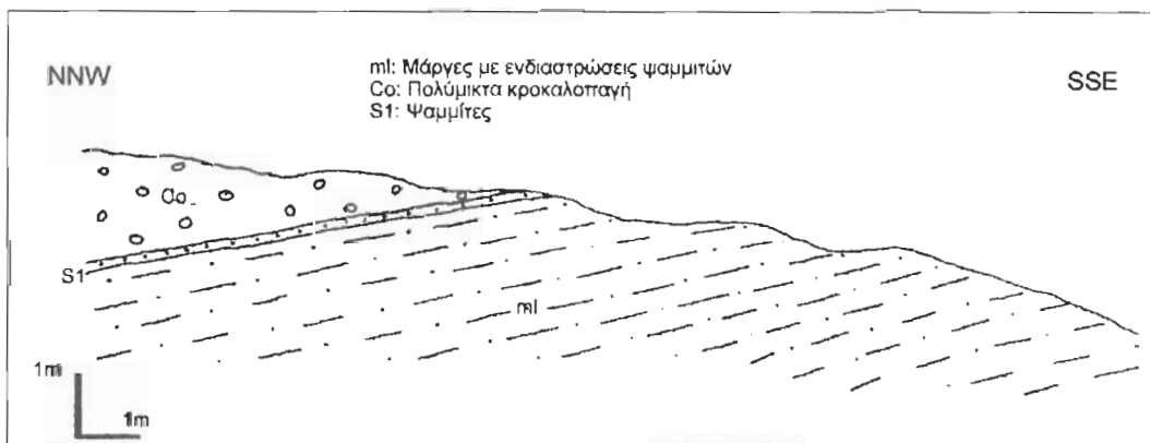
Ειχ. 3: Σχηματική γεωλογική τομή στο σχηματισμό Νέδα στη θέση 5
