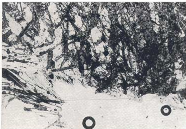
Abb. 8. Chloritoidbildung aus Staurolith. Staurolithrelikte sind noch zu erkennen (im Bild etwas heller) — (// Nikols, 50-fach vergrößert).
