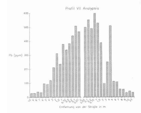
Abb. 2 Pb-Konzentration in Abhängigkeit von der Entfernung zur Straβe
