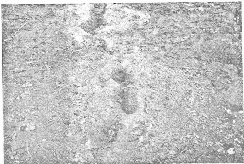
Εικ. 8. Εκτίναξη κατά μήκος εδαφικής διαρρήξης. Διακρίνεται εκατέρωθεν της διαρρήξης οι αποθέσεις άμμου - χαλικών και ιλύος.
