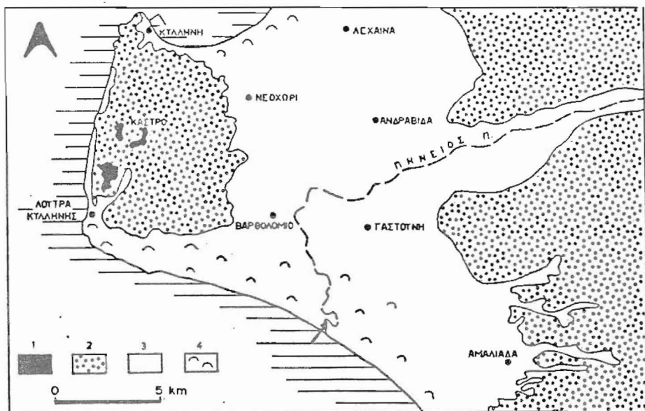
Εικ. 2. Απλουτεμένος γεωλογικός χάρτης της ευρύτερης περιοχής εμφάνισης των φαινομένων εκτίναξης νερού και άμμου καθώς και των εδαφικών διαρρήξεων. Η θέση τους σημειώνεται με το βέλος. (1. Αλπικοί σχηματισμοί της Ιονίου Ενότητας, 2. Πλειο-Πλειστοκαινικοί σχηματισμοί, 3. Αλλούβια, 4. Θ(νες).
