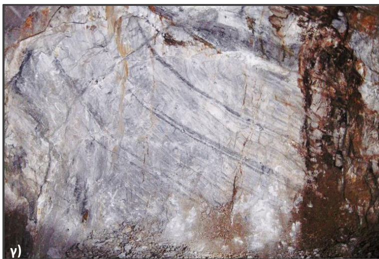
Εικόνα 4.5 Τυπικά μάρμαρα α) λεπτόκοκκα, ζωνώδη, από τη γεώτρηση OLDD0006 στα 215,70 – 219,90 m, β) μεσόκοκκα, πλούσια σε γραφίτικα φλεβίδια, από τη γεώτρηση OLDD0023 στα 54.00 – 56.70 m, γ) με γραφίτικές ζωνώσεις, από το επίπεδο -100 της Ανατολικής Πρόσβασης (East Access).
