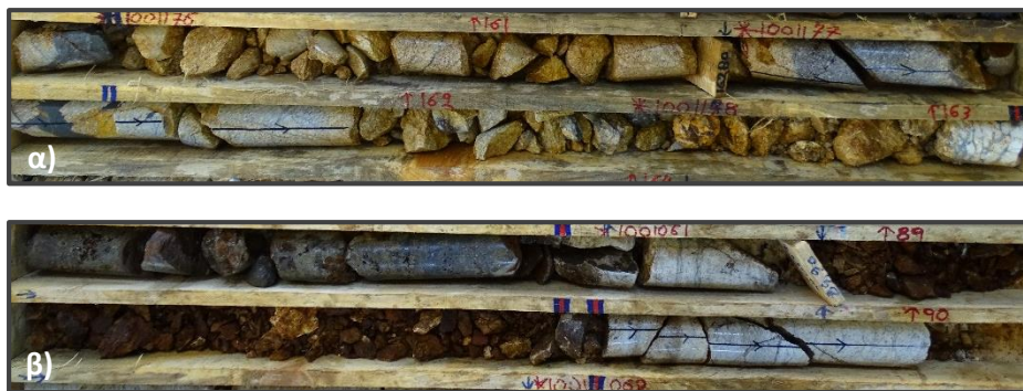
Εικόνα 4.11 Έντονα κερματισμένα και αποδιοργανωμένα μάρμαρα α) πλησίον της μεταλλοφορίας, με χαρακτηρισες μυλωνιτώσεως και τεκτονικού λατυποπαγούς (breccia), από τη γεώτρηση OLDD0018 στα 161,50 - 164,50 m, β) σε επαφή με τη μεταλλοφορία και με έντονη παρουσία μαγνητοξειδίων, από τη γεώτρηση OLDD0019 στα 89,90 - 90,60 m.
