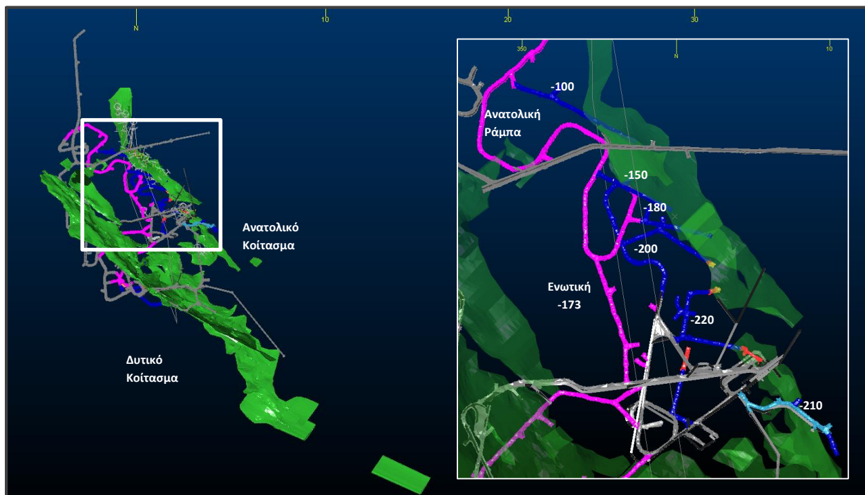
Σχήμα 5.7 Απόσπασμα από το χώρο εργασίας του λογισμικού Datamine Studio 3 όπου απεικονίζεται, με μορφή τρισδιάστατου μοντέλου, η δομή του κοιτάσματος Ολυμπιάδας και οι στοές στις οποίες διεξήχθησαν οι χαρτογραφήσεις μετώπων.
