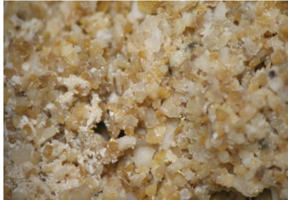
Εικ. 5.1.2β: Φωτογράφιση εξωτερικής επιφάνειας δείγματος 2 σε στερεοσκόπιο. Η μεγάλη διάσταση της εικόνας είναι 7mm.
