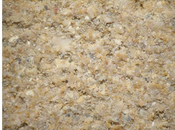
Εικόνα 5.1.20β: Φωτογράφιση του δείγματος 20 σε στερεοσκόπιο. Κλίμακα: Η μεγάλη διάσταση της εικόνας είναι 11mm
