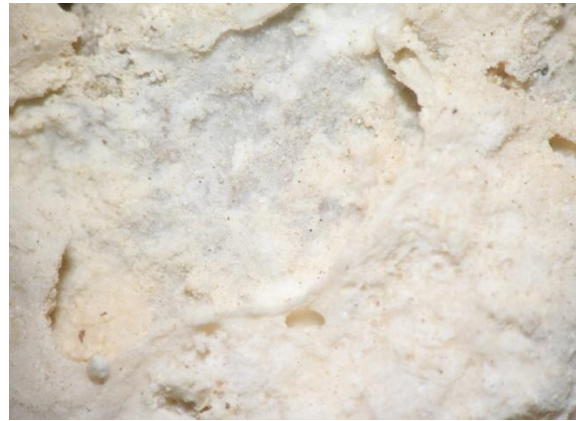
Εικόνα 5.1.16β: Φωτογράφιση εξωτερικής επιφάνειας του δείγματος 16 σε στερεοσκόπιο. Κλίμακα: Η μεγάλη διάσταση της εικόνας είναι 11mm
