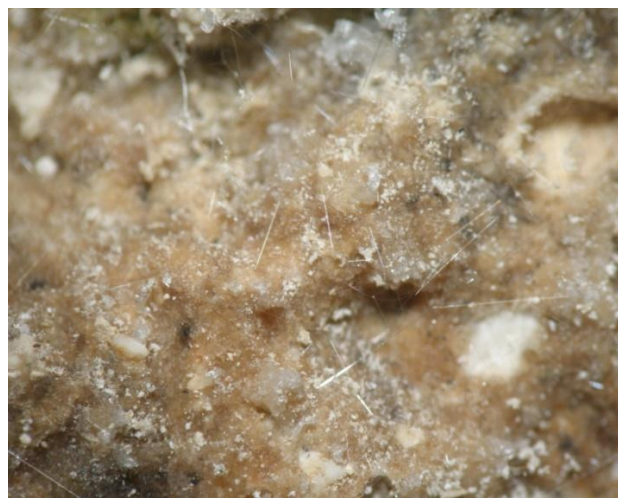
Εικόνα 5.1.13β: Φωτογράφιση εξωτερικής επιφάνειας του δείγματος 13 σε στερεοσκόπιο. Κλίμακα: Η μεγάλη διάσταση της εικόνας είναι 11mm
