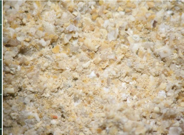
Εικόνα 5.1.12β. Φωτογράφιση εξωτερικής επιφάνειας του δείγματος 12 σε στερεοσκόπιο. Κλίμακα: Η μεγάλη διάσταση της εικόνας είναι 11mm
