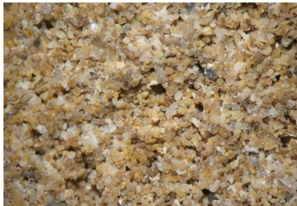
Εικ. 5.1.1β: Φωτογράφιση δείγματος 1 σε στερεοσκόπιο. Η μεγάλη διάσταση της εικόνας είναι 11mm.
