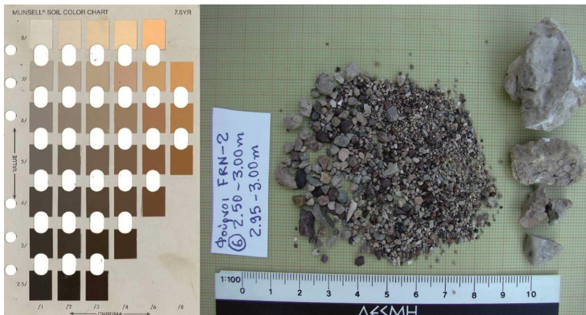
Εικόνα 15. Στα αριστερά απεικονίζεται τμήμα της χρωματικής κλίμακας Munsell και στα δεξιά δείγμα της γεώτρησης FRN-2 κατά τη διαδικασία της φωτογράφισης πριν τη στερεοσκοπική παρατήρηση (φωτογράφιση από Συρίδης).
