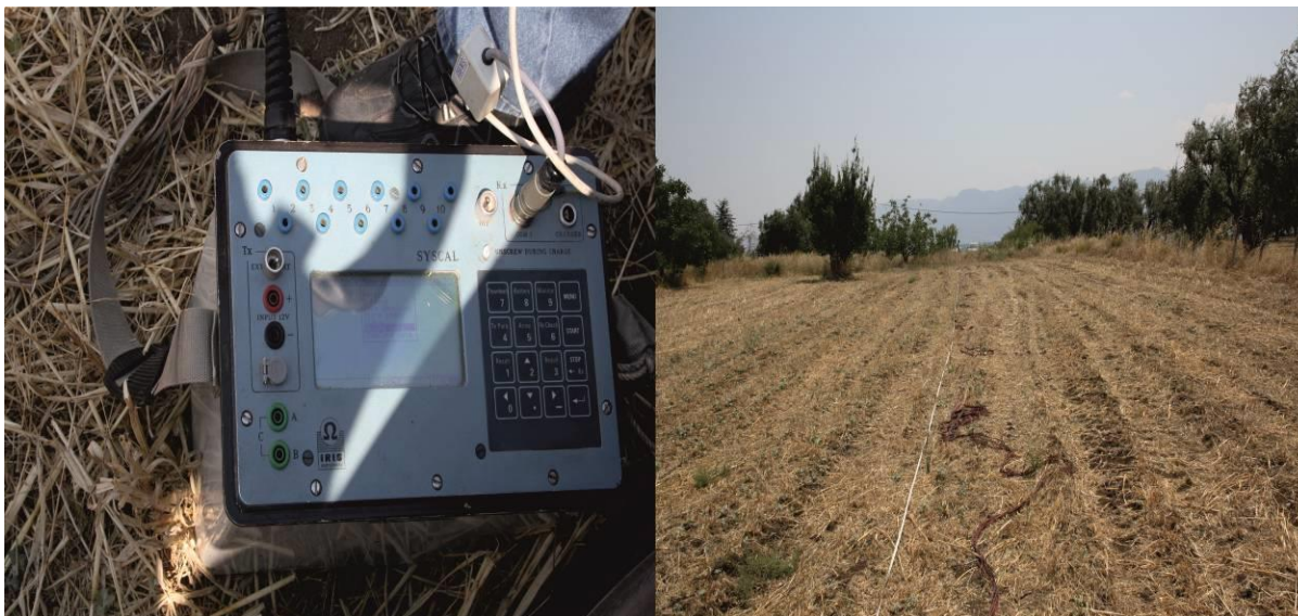
Εικόνα 13. Στα αριστερά της εικόνας απεικονίζεται το όργανο Syscal Pro της Iris Instrument που χρησιμοποιήθηκε στη γεωφυσική διασκόπηση και δεξιά άποψη από την ηλεκτρική τομογραφία ert-3 (φωτογράφιση από Καλπάκη).
