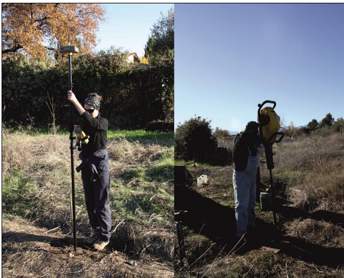
Εικόνα 12. Στιγμιότυπα από τις διαδικασίες της γεωμορφολογικής χαρτογράφησης (αριστερά) και της εκτέλεσης δειγματοληπτικής γεώτρησης (δεξιά) στην περιοχή έρευνας (φωτογράφιση από Καλπάκη).
