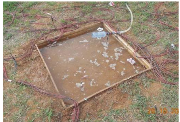
Σχήμα 5.13 Περιοχή που πραγματοποιήθηκαν οι μετρήσεις. Δεξιά φαίνεται το σκάμμα που ανοίχτηκε και πληρώθηκε με νερό για τη μέτρηση της κατείσδυσης. Η παροχή του νερού ήταν σταθερή και τα αποτελέσματα της ηλεκτρικής τομογραφίας συγκρίθηκαν και με υδρογεωλογικές μετρήσεις κατείσδυσης.
