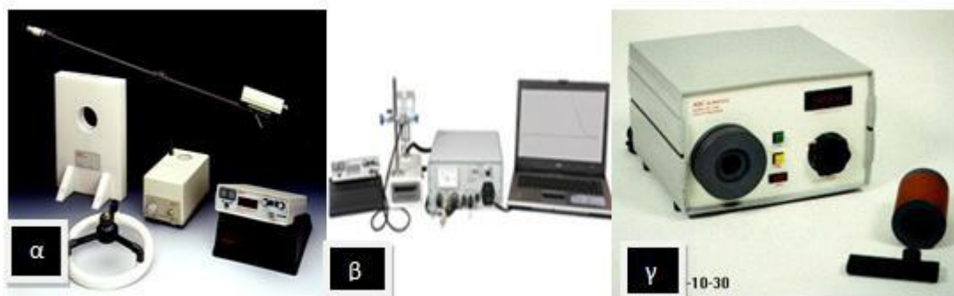
Σχήμα 4.10. Σειτ οργάνων μέτρησης της μαγνητικής επιδεκτικότητας σε θερμοκρασία δωματίου. (β) Σειτ οργάνων μέτρησης της μαγνητικής επιδεκτικότητας σε συνάρτηση με τη θερμοκρασία. (γ) Όργανο απόκτησης ισόθερμης παραμένουσας μαγνήτισης (IRM) (Εργαστήριο Γεωφυσικής, ΑΠΘ).
