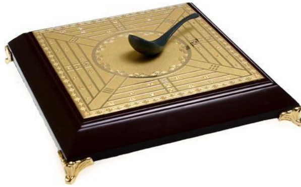
Σχήμα 1.1. Η πρώτη γνωστή μορφή μαγνητικής πυξίδας που επινοήθηκε από τον Wang Chen Το. Επανακατασκευάστηκε από τον Needham το 1962 με την έγκριση του πανεπιστημίου του Cambridge (Needham, 1962; Merrill et al., 1996).
