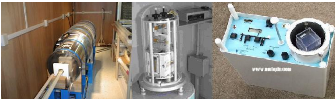
Σχήμα 4.9. Τύποι μαγνητομέτρων.(α) Κρυογενετικό μαγνητόμετρο ( www.soest.hawaii.edu ), (β) Μαγνητόμετρο ροής ( www.bgs.ac.uk ), (γ) Περιστροφικό μαγνητόμετρο ( www.ascscientific.com ).
