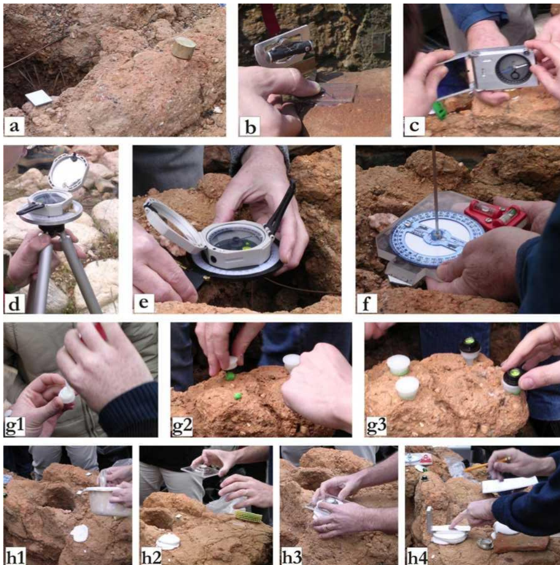
Σχήμα 4.4. Διαφορετικές τεχνικές προσανατολισμού δειγμάτων.
