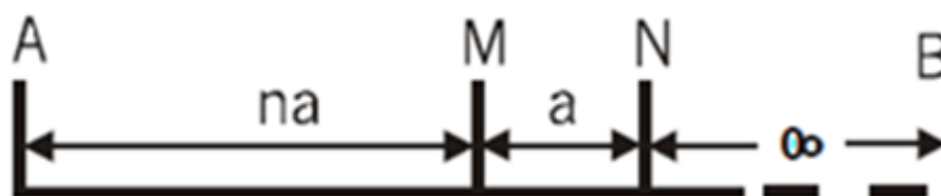
Σχήμα 27: Σχηματική απεικόνιση διάταξης πόλου-πόλου. ( http://www.geo.auth.gr/courses/qgp/qgp762e/PDF/LEC3_NEW.pdf )
