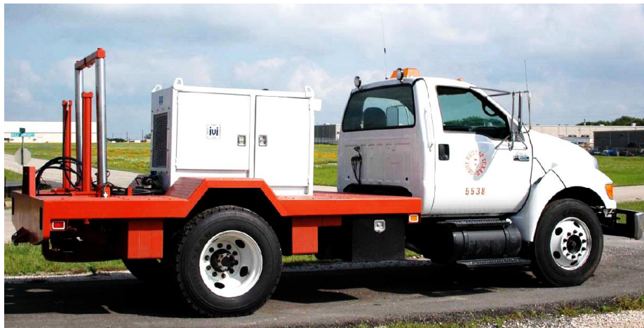
Σχήμα 13 : Πηγή παραγωγής ελαστικών κυμάτων Thumper . ( http://www.geo.auth.gr/courses/ggp/ggp432e/PDF/EISAGOGH-3.pdf )
