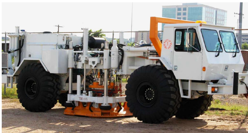
Σχήμα 15 : Πηγή παραγωγής ελαστικών κυμάτων Vibroseis. ( http://www.geo.auth.gr/courses/ggp/ggp432e/PDF/EISAGOGH-3.pdf )
