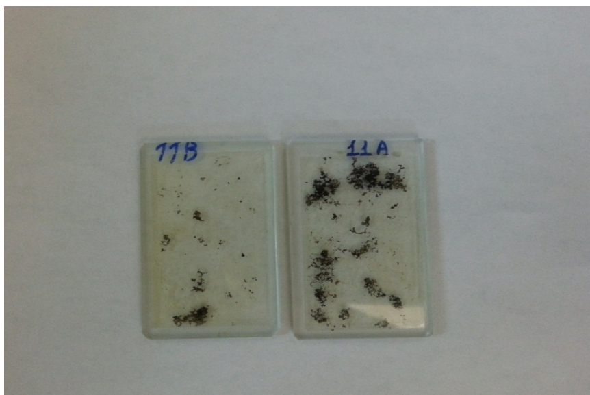
Εικόνα 3. Δείγμα Baltic Brown . 11Α τομή υγιούς δοκιμίου και 11Β τομή δοκιμίου μετά την δοκιμή της Ψύξης-Απόψυξης.
