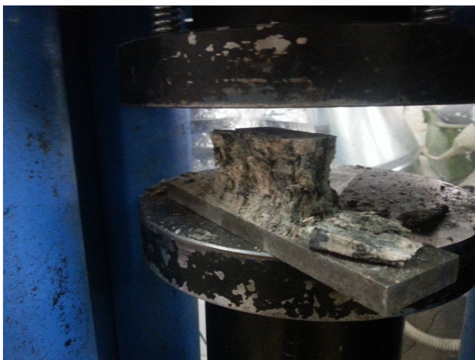
Εικόνα 2. Δείγμα Baltic Brown μετά το πέρας της δοκιμασίας Μονοαξονικής Αντοχής.
