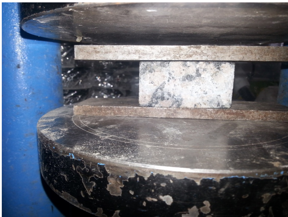
Εικόνα 1. Δείγμα Baltic Brown πριν την διαδικασία Μονοαξονικής Αντοχής.
