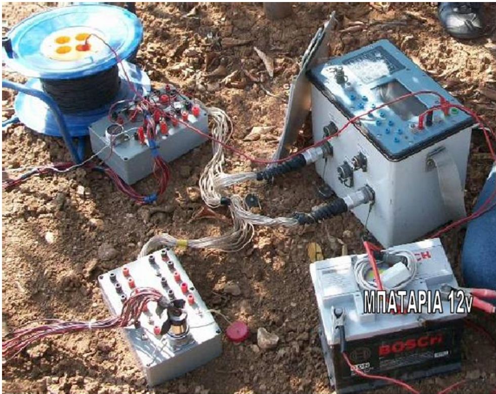
Σχήμα 4.5. Όργανο λήψης ηλεκτρικών μετρήσεων SYSCAL-PRO της εταιρείας IRIS INSTRUMENTS μαζί με τον πρόσθετο εξοπλισμό και τη συνδεσμολογία που χρησιμοποιήθηκε κατά τη διάρκεια της μέτρησης.
