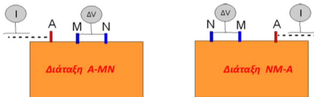
Σχήμα 2.6 : Διαμορφώσεις διάταξης πόλου- διπόλου
