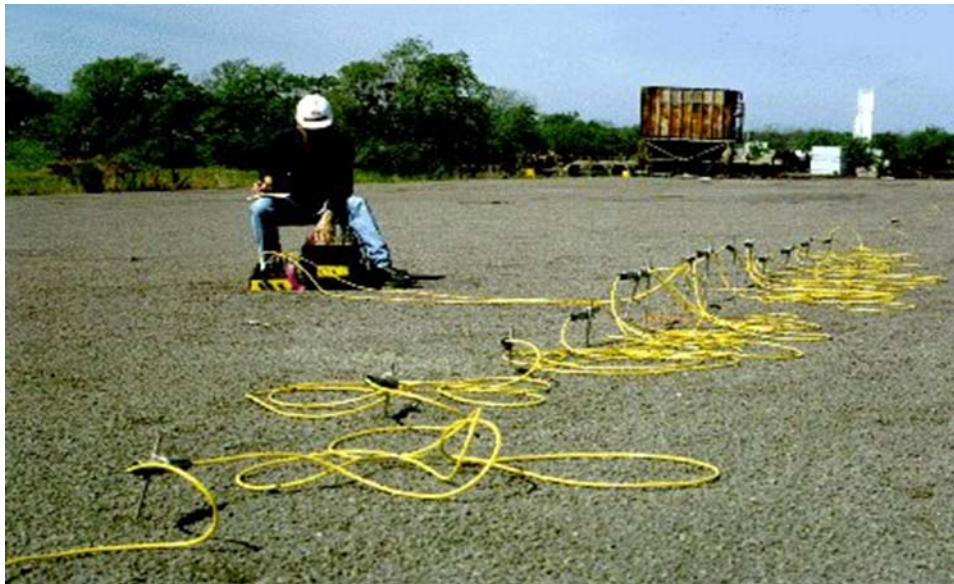
Σχήμα 2.8 : Πολυκάναλο σύστημα λήψης μετρήσεων ηλεκτρικής τομογραφίας
