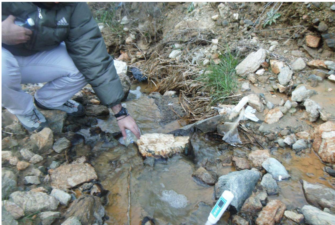
Σχήμα 1.8 : Δειγματοληψία νερού από ρέμα της περιοχής για τη διαδικασία χημικής ανάλυσης
