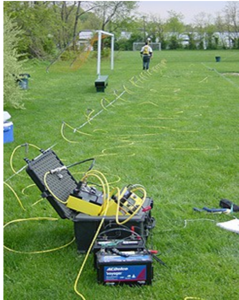
Εικόνα 15: Λήψη υπαίθριων μετρήσεων για την υλοποίηση ηλεκτρικής τομογραφίας.
