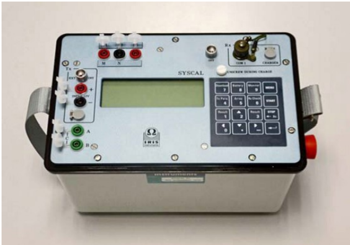
Εικόνα 23: Όργανο μέτρησης αντιστάσεων της εταιρείας SYSCAL Pro
