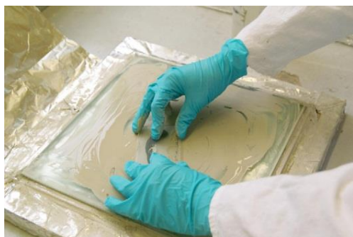
Σχ.32 URL24 Διαδικασία επεξεργασίας διθύρου Βήμα 6ο. Λείανση λεπτής τομής.
