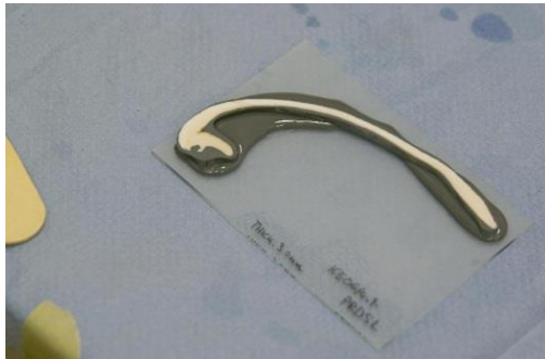
Σχ.34 URL24 Διαδικασία επεξεργασίας διθύρου Βήμα 8ο. Προσκόλληση σε αντικειμενοφόρο πλάκα.
