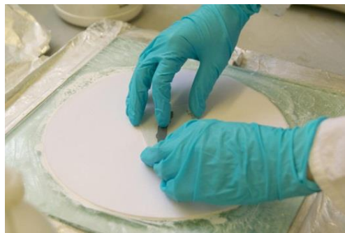
Σχ.33 URL24 Διαδικασία επεξεργασίας διθύρου Βήμα 7ο. Στίλβωση λεπτής τομής.
