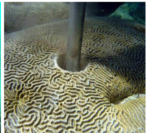
Σχ.22 URL 19 Διαδικασία λήψης πυρήνα κοραλλιού βήμα 3ο. Υποβρύχια δειγματοληψία που χρησιμοποιεί χειροκίνητο τρυπάνι.
