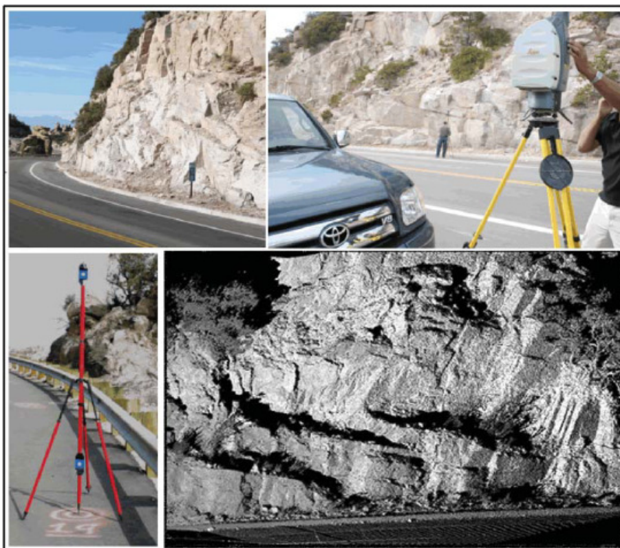
Εικόνα 4.6 Πρότυπο ικανοποιητικής σάρωσης ( Kemeny, John and Turner, Keith, 2008 )
