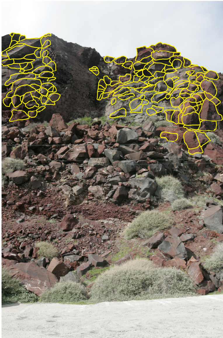
Εικόνα 11.12 Άποψη της θέσης Π2 στην περιοχή του Πάρκινγκ και ανάλυση επικρεμάμενων τεμαχών με το λογισμικό CorelDRAW.
