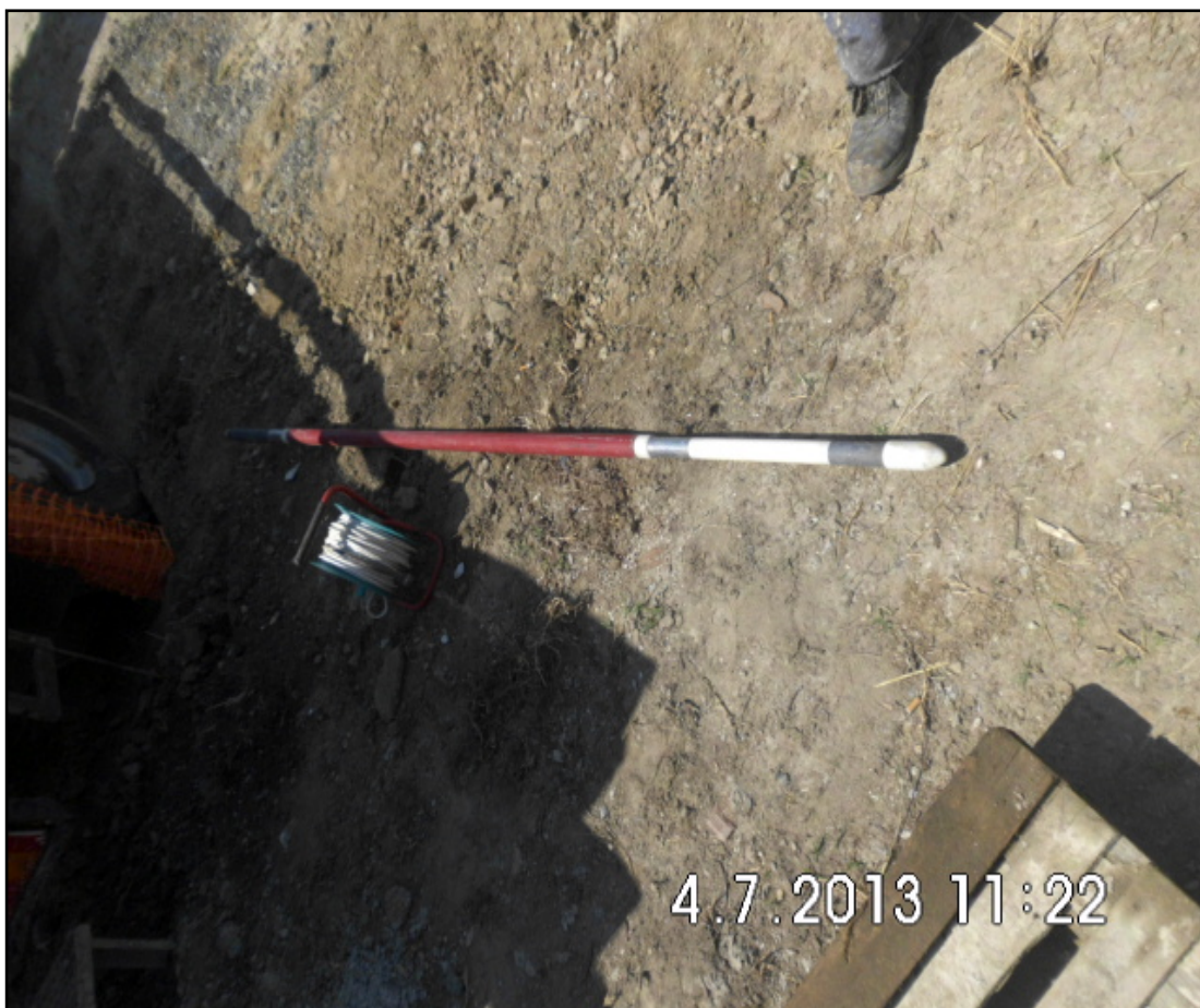
Εικόνα 5. Αισθητήρας Διαγραφιών (θερμοκρασία, αγωγιμότητα και ακτινοβολία γ).
