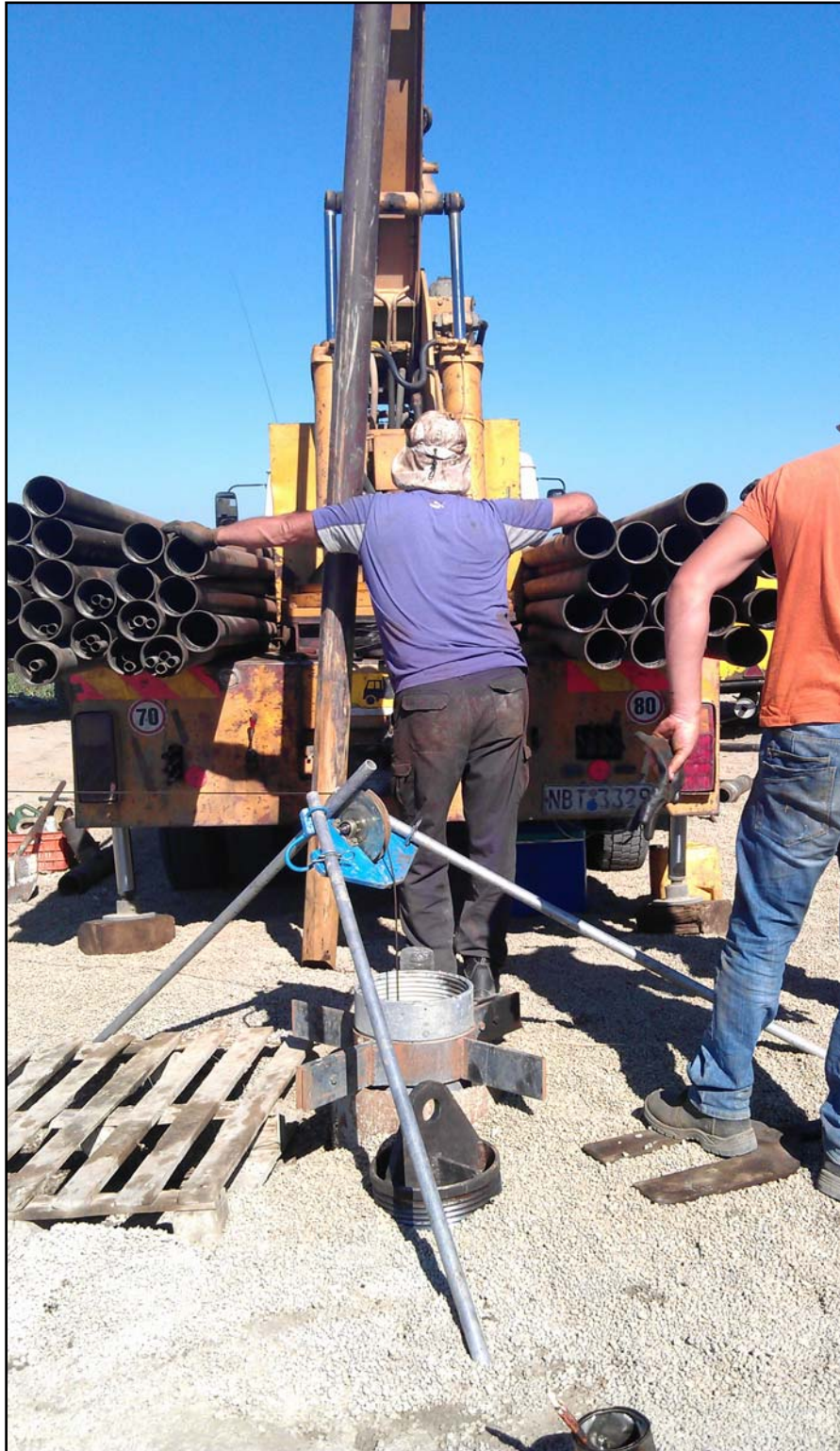
Εικόνα 6. Κάθοδος αισθητήρα για την καταγραφή της ηλεκτρικής αντίστασης των σχηματισμών.
