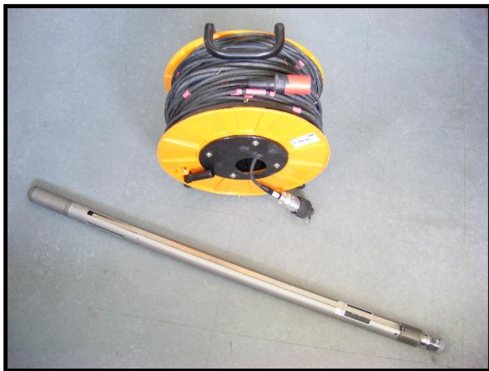
Εικόνα 3.4 Προστατευτικό σώμα –βολίδα γεωφώνων. Παρατηρείται το έλασμα σταθεροποίησης, καθώς και το καλώδιο σύνδεσης του δεκτη με τον καταγραφέα.
