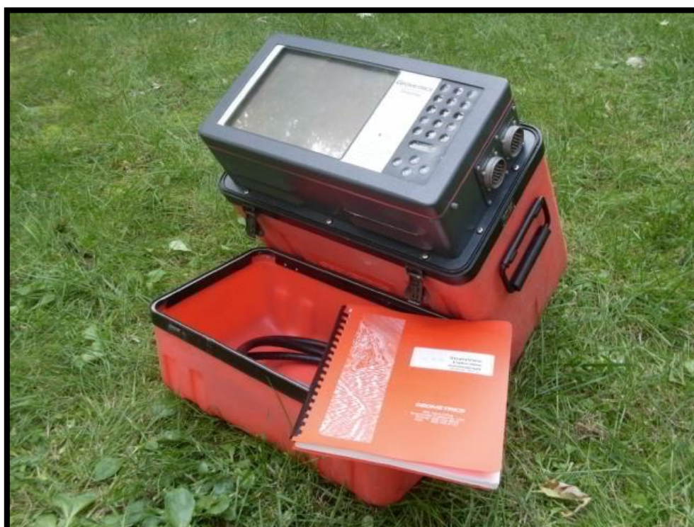
Εικόνα 3.5 Φορητό όργανο καταγραφής 24 ων καναλιών “Strata View”. Κατασκευαστής: Geometrics.
