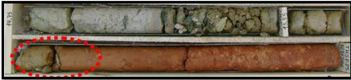
Εικόνα 4.6 Φωτογραφία όπου φαίνεται η ομαλή επαφή Ψαμμιτομαργαϊκής σειράς και σειράς Ερυθρών Αργίλων από γεώτρηση του Μετρώ Θεσσαλονίκης στην περιοχή Παπάφειου (Αττικό Μετρώ).
