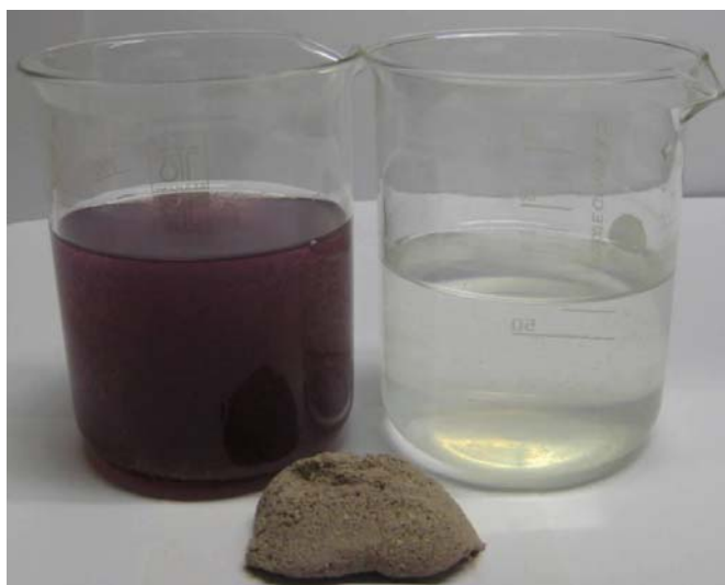
Σχήμα 4. Καθαρισμός βιομηχανικών υγρών αποβλήτων βαφείου, (Αριστερά) Αρχικό υγρό απόβλητο βαφείου, (Δεξιά) Καθαρό νερό μετά την κατεργασία με πολύ υψηλής ποιότητας ζεολιθικό τόφο, (Κέντρο) Άοσμη και συνεκτική ζεο-λάσπη (Filippidis 2010a).
