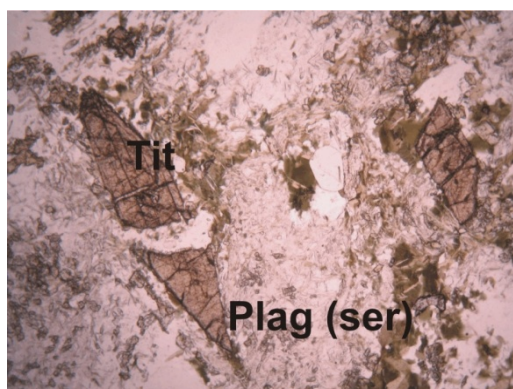
Σχήμα 13. Τομή T15. Γνεύσιος. Μεγέθυνση: 10X. Tit: τιτανίτης, Plag (ser): σερικιτωμένο πλαγιόκλαστο
