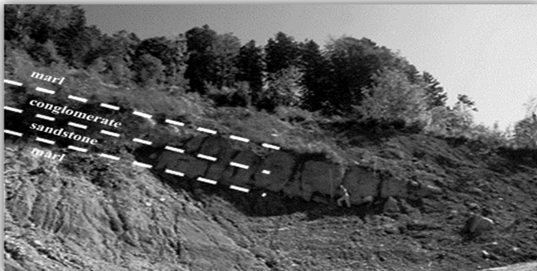
Εικόνα 4.10 : Συχνότητα διαστρωμάτωσης των κροκαλοπαγών και των μαργών κατά μήκος των ορίων της κατολίσθησης του Rufi, Eberhardt, E., Thuro1, K., Luginbuehl, M., 2005
