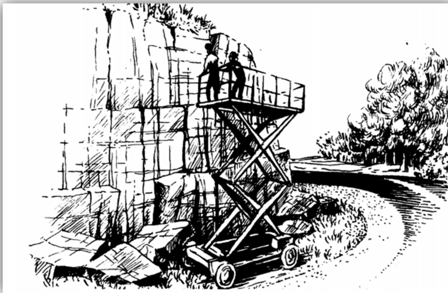
Σχήμα 4.42 : Κινητή πλατφόρμα που παρέχει πρόσβαση στα ανώτερα τμήματα του πρανούς, Farquhar, O.C., 1980
