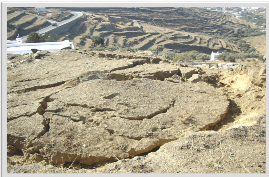
Εικόνα 3.11 : Μεταθετική ολίσθηση σε υλικά της ζώνης αποσάθρωσης και κερματισμού σχιστόλιθων, [51]
