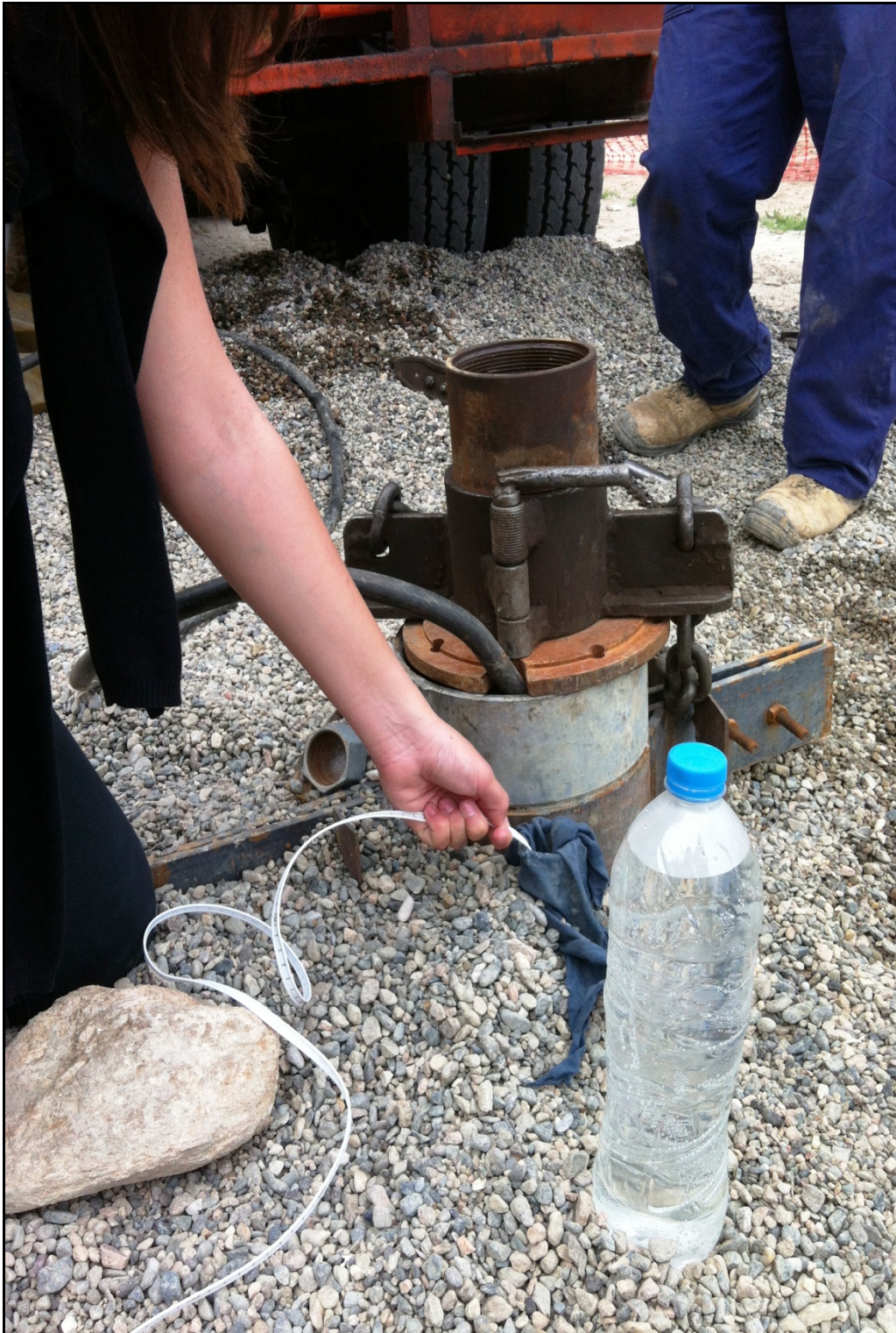
Φωτογραφία 5: Εικόνα από τη μέτρηση πτώσης στάθμης και συλλογή δείγματος νερού.
