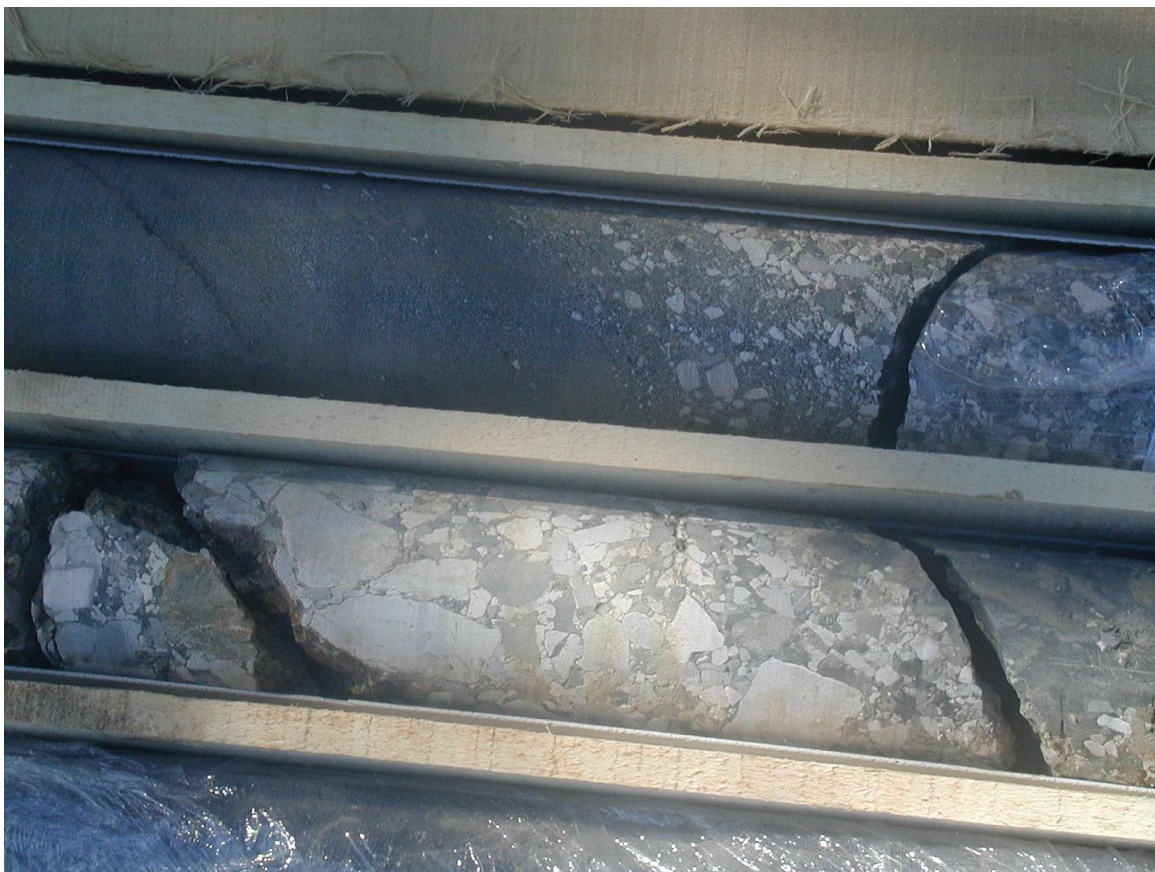
ΕΙΚΟΝΑ 3-14 Εμφάνιση κροκαλοπαγών σε πυρήνα γεώτρησης (Μαρίνος,2007)
