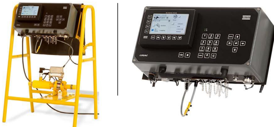
Σχ. 31: Εξοπλισμός για την παρακολούθηση σε πραγματικό χρόνο των δοκιμών Lugeon και των τσιμεντενέσεων.
