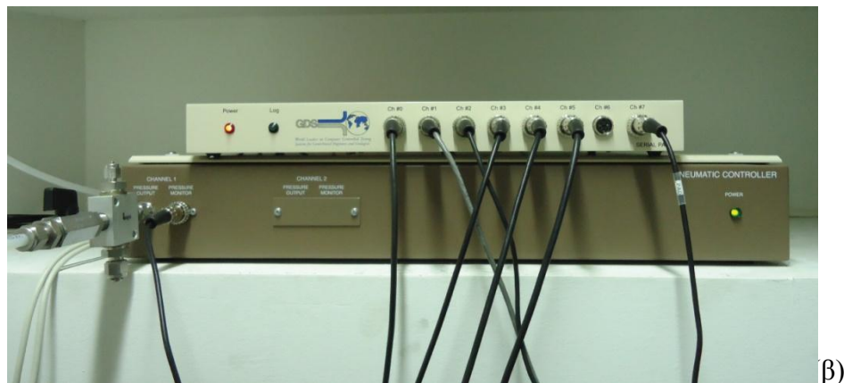
Εικόνα 21. (α) Ηλεκτρονικός ελεγκτής υψηλής ακρίβειας νερού "Standard Pressure/Volume Controller (STDDPC) v2", (β) Πνευματικός ελεγκτής υψηλής ακρίβειας αέρα " Pneumatic Pressure Controller (GDSPPC)".
