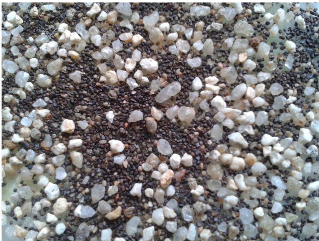
Σχήμα 4.4.2.4: Κλάσμα 3. Κόκκοι βαρέων ορυκτών μεγέθους 0Φ (1mm) και 0,5 Φ (0.707mm) μαζί με αδρανή ορυκτά (πυριτικά) μεγέθους -1Φ (2mm) και -1,5 Φ (3mm)
