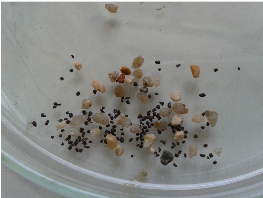
Σχήμα 4.4.2.2: Κλάσμα 1. Κόκκοι βαρέων ορυκτών μεγέθους 0Φ (1mm) και 0,5 Φ (0.707mm) μαζί με αδρανή ορυκτά (πυριτικά) μεγέθους -1Φ (2mm) και -1,5 Φ (3mm)
