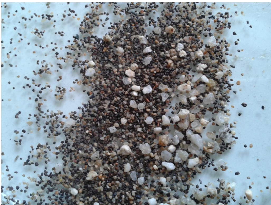
Σχήμα 4.4.2.3: Κλάσμα 2. Κόκκοι βαρέων ορυκτών μεγέθους 0Φ (1mm) και 0,5 Φ (0.707mm) μαζί με αδρανή ορυκτά (πυριτικά) μεγέθους -1Φ (2mm) και -1,5 Φ (3mm)
