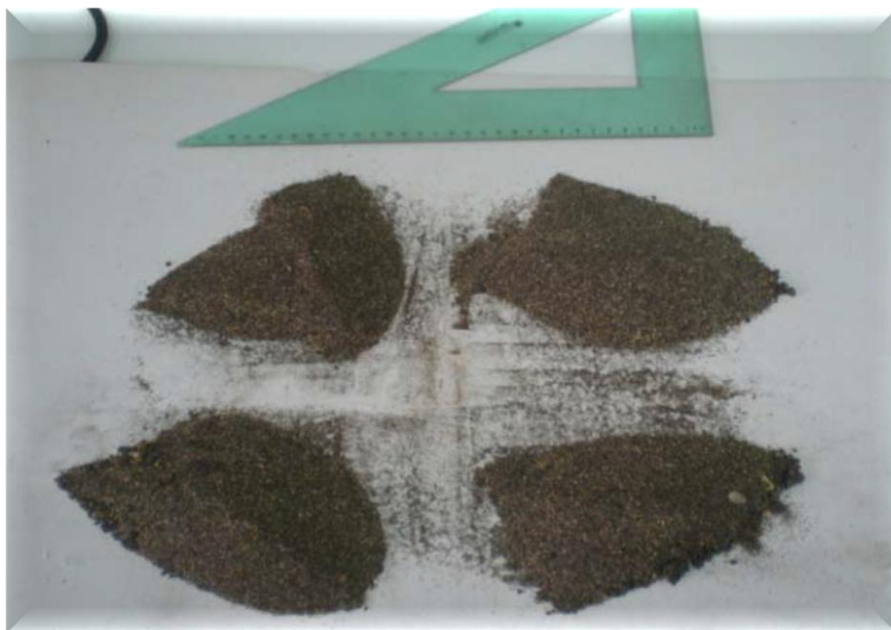
Εικόνα 3.: Διαχωρισμός δείγματος με τη μέθοδο του σταυρού
