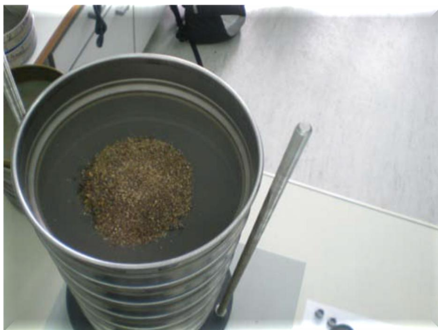
Εικόνα 3.: Διαχωρισμός δείγματος με τη μέθοδο του σταυρού
