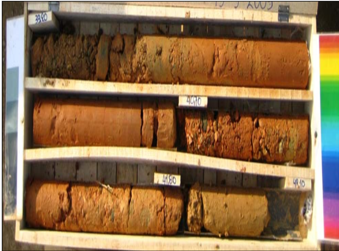
Σχήμα 44. Ορίζοντες λατυποπαγούς εντός των ερυθρών αργίλων στην γεώτρηση TGSP47 του σταθμού Πανεπιστήμιο (βάθος 39.2 – 42.1 m) (Κ/Ξ ΚΑΤΑΣΚΕΥΗΣ ΜΕΤΡΟ ΘΕΣΣΑΛΟΝΙΚΗΣ, 2014)
