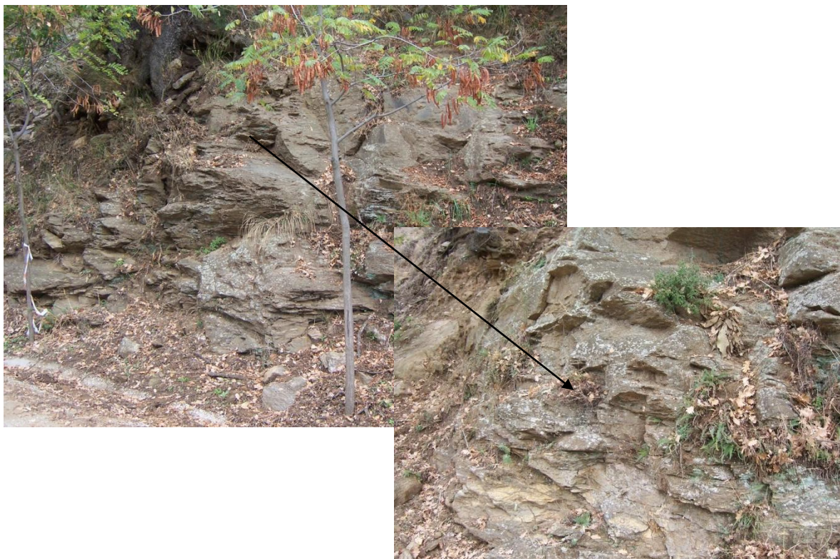
Εικ.6.6: Οι μαρμαρυγιακοί σχιστόλιθοι στο πρανές δεξιά από το ανατολικό όριο της κατολίσθησης και σε λεπτομέρεια οι ασυνέχειές του.
