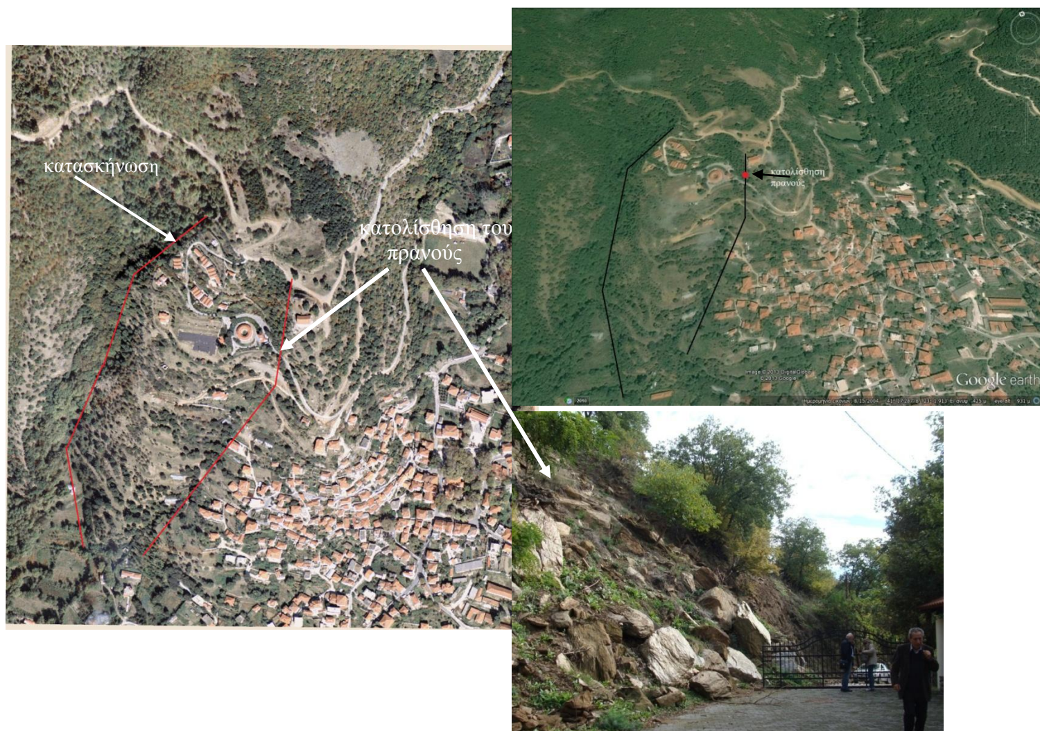
Εικ.5.2.3: Ο χώρος της κατασκήνωσης που εκτείνεται μέσα στην ευρύτερη παλιότερη κατολίσθηση. Επίσης, σημειώνεται η κατολίσθηση του πρανούς στην είσοδο της κατασκήνωσης. Με γραμμές περικλείεται ο χώρος της παλιότερης κατολίσθησης. Η κάτω δεξιά φωτογραφία απεικονίζει την κατολίσθηση του πρανούς.
