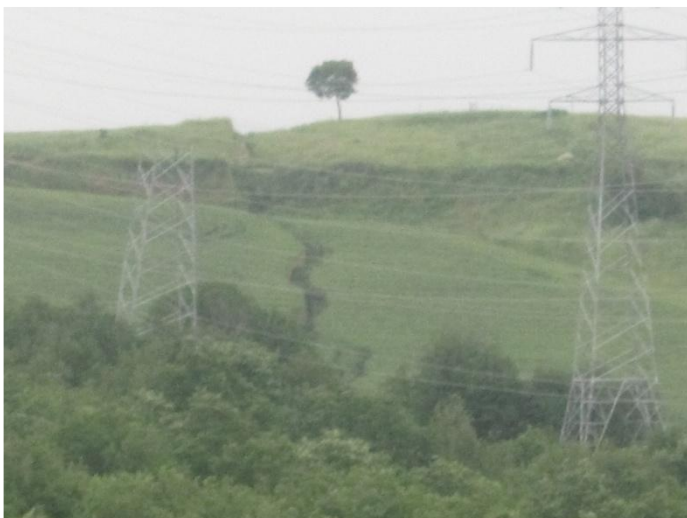
Σχήμα 5.1.2 Επιφανειακές ρωγμές ανάμεσα στον οικισμό και το ορυχείο κοντά στο μέτωπο του ορυχείου
