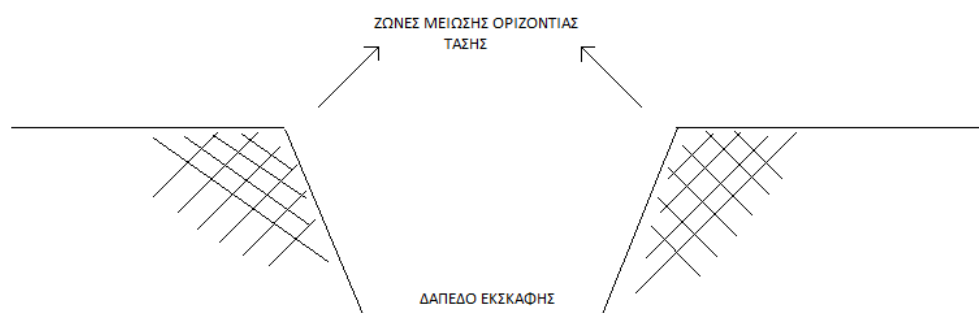
Σχήμα. 4.1 Ζώνες μειωμένης οριζόντιας τάσης σε μια μεγάλη εκσκαφή.
