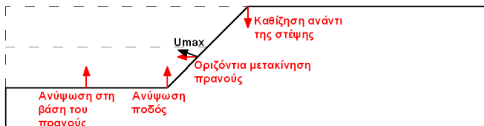
Σχήμα 4.3.2: Τυπική γεωμετρία πρηνούς και κύριες μετακινήσεις
