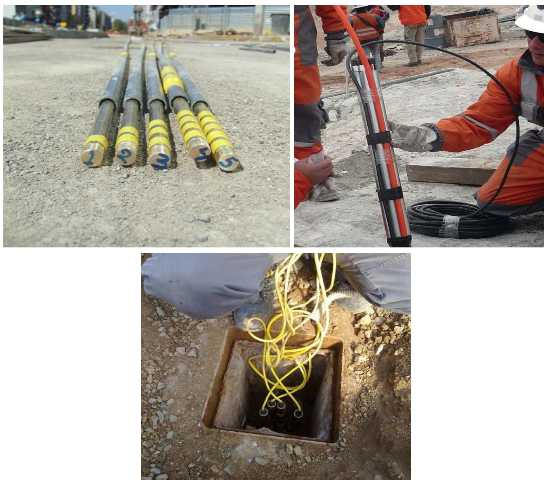
Σχήμα 1.4.2: Εικόνα από εξτενσιόμετρο (κεφαλές) και κάτω πως τοποθετείται στο έδαφος.
