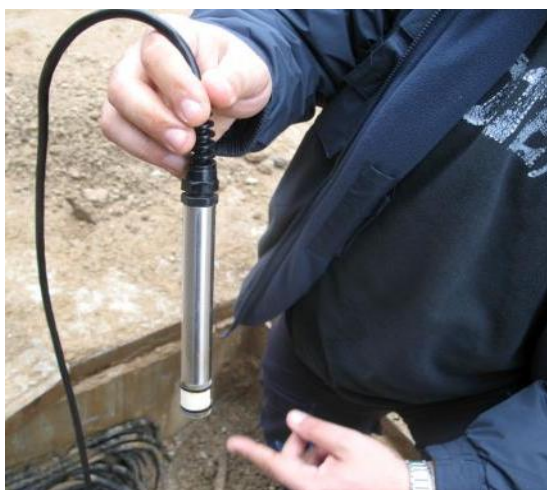
Σχήμα 1.4.3: Εικόνα από πιεζόμετρο και τοποθέτηση πιεζομέτρου για λήψη στάθμης
