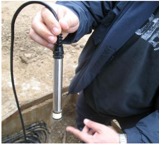
Εικόνα από πιεζόμετρο και τοποθέτηση πιεζομέτρου για λήψη στάθμης
