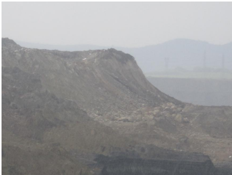
Σχήμα 5.3.2: Περιστροφικές ολισθήσεις, εντός των τεταρτογενών, στη θέση του ορυχείου Μαυροπηγής.
