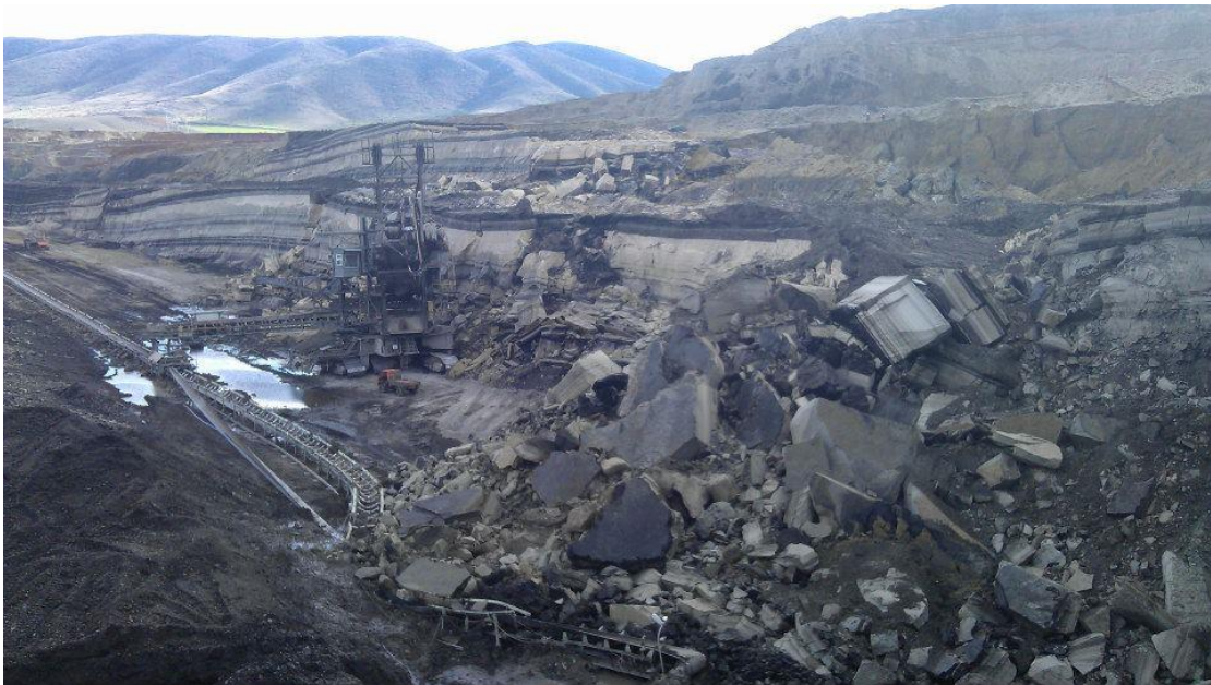
Σχήμα 5.3.1: Κατολίσθηση που περιλαμβάνει τους τεταρτογενείς σχηματισμούς και τη μάργα, φαίνονται τα άρρηκτα τεμάχια μάργας, προκλήθηκε στο ορυχείο Μαυροπηγής στις 14-01-2014.
