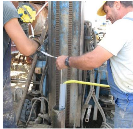
Εικόνα από πιεζόμετρο και τοποθέτηση πιεζομέτρου για λήψη στάθμης
