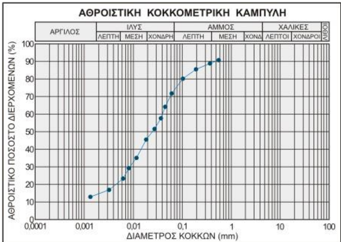
Σχήμα 1.2.1: Αθροιστική κοκκομετρική καμπύλη εδαφικού σχηματισμού. (Κ. Βουδουρης θέματα υδρογεωλογίας και περιβάλλοντος).
