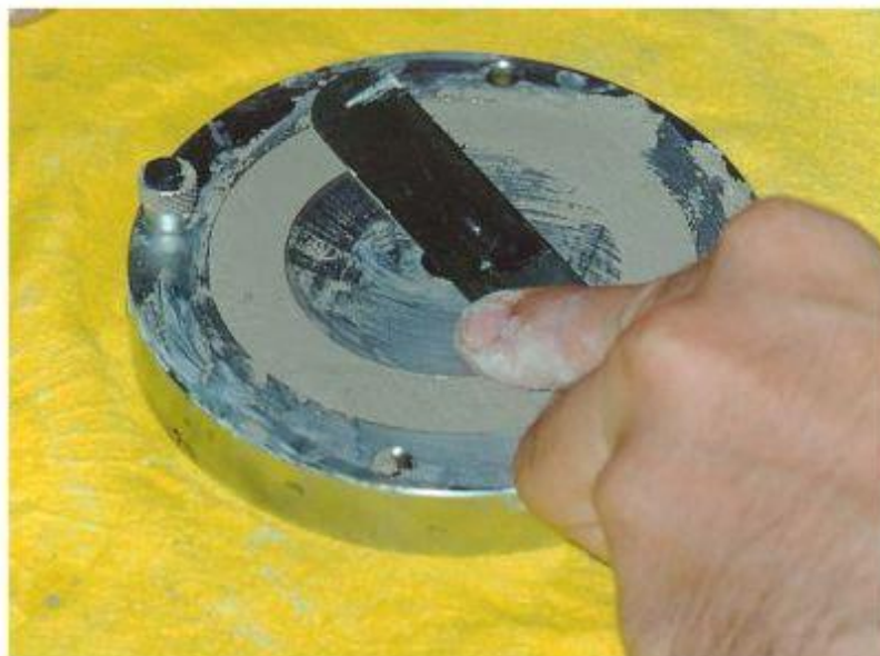
Σχήμα 1.2.4: Τοποθέτηση αναζυμωμένου δείγματος μάργας στη δακτυλοειδή μήτρα. ( Ε.Κ. ΣΤΕΙΑΚΑΚΗΣ 2003).
