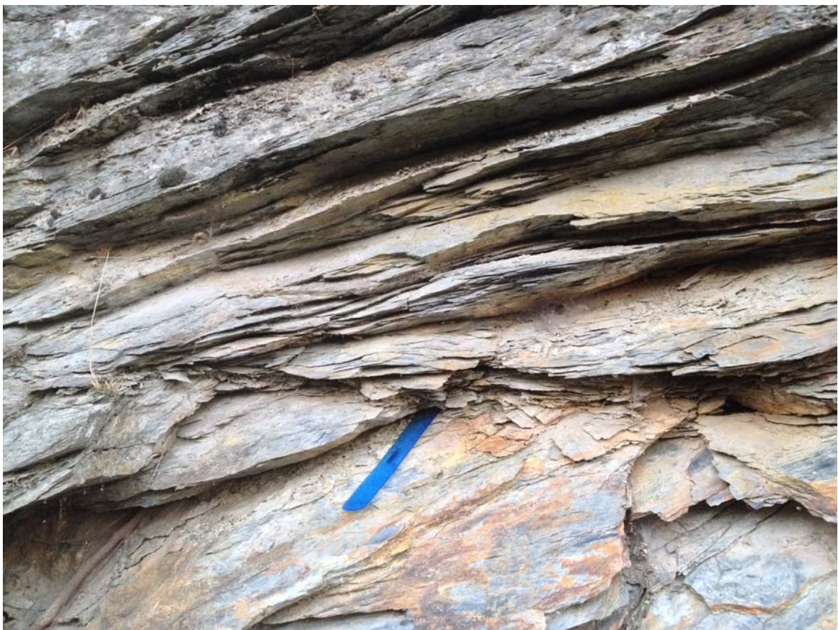
Εικόνα 3.10 Γραφικός σχιστόλιθος, διακρίνεται η σχιστότητα και το υλικό πλήρωσης, (Κ. – Μ. Ιουρασικό, φωτογραφία από το σημείο μελέτης)
