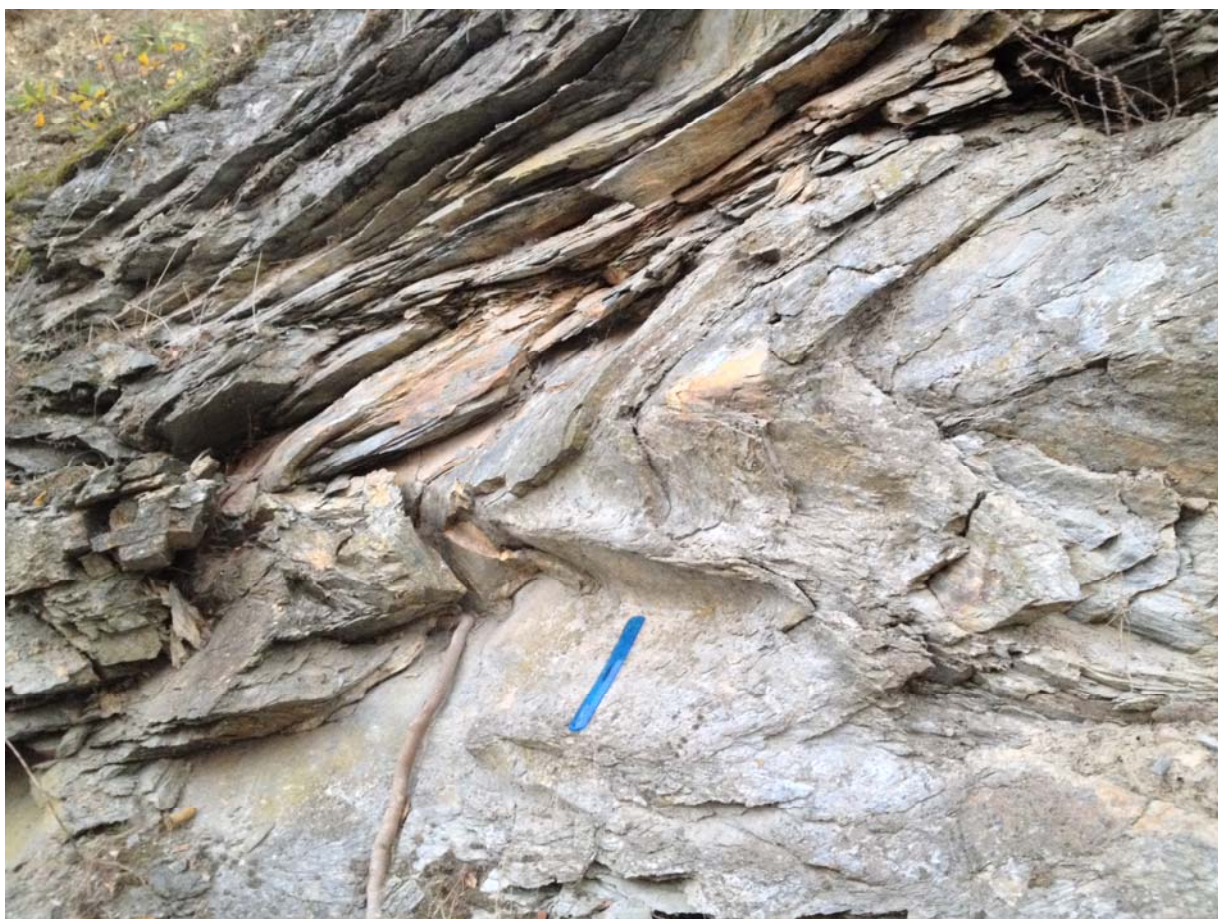
Εικόνα 3.11: Γραφιτικός σχιστόλιθος , (Κ. – Μ. Ιουρασικό, φωτογραφία από το σημείο μελέτης), παρατηρείται η έντονη σχιστότητα καθώς και η πτύχωση.
