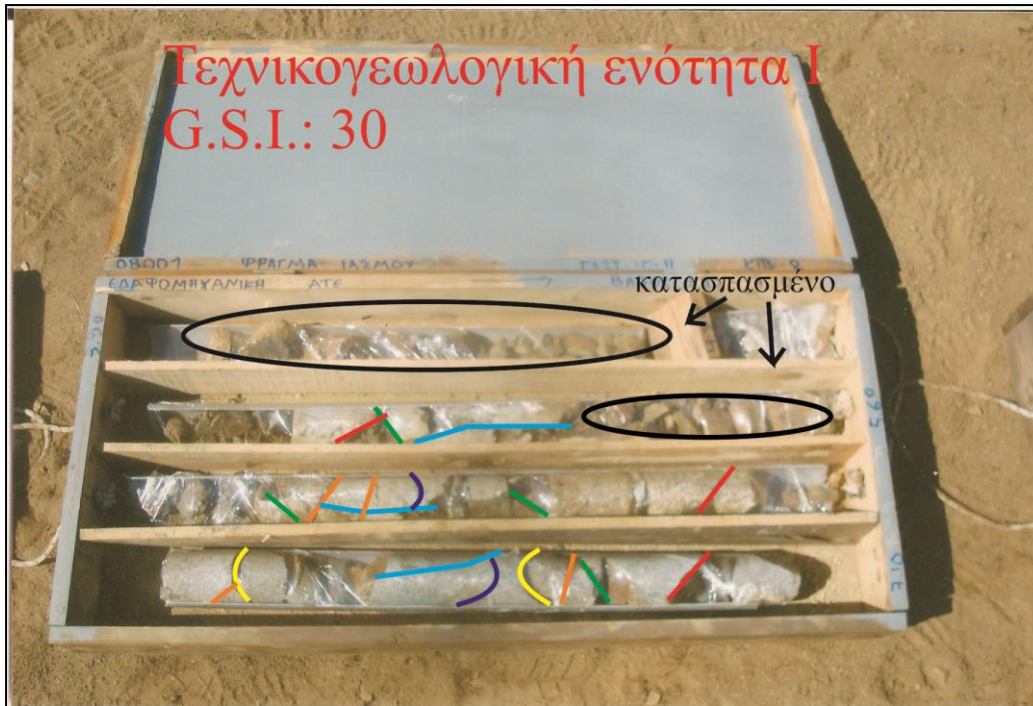
Σχήμα 23: Δείγμα της ποιότητας της βραχώμαζας για την τεχνικογεωλογική ενότητα I.
