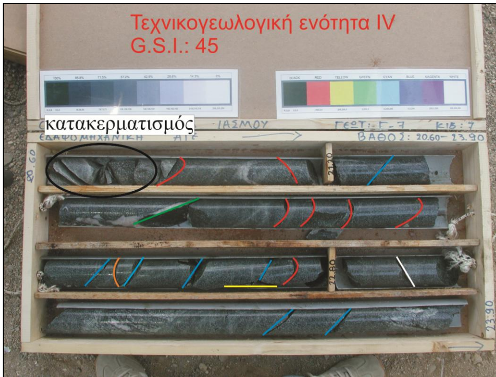
Σχήμα 34: Δείγμα της ποιότητας της βραχώμαζας για την τεχνικογεωλογική ενότητα III.
