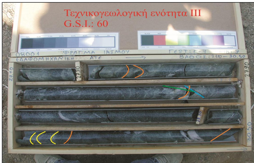
Σχήμα 30: Δείγμα της ποιότητας της βραχώμαζας για την τεχνικογεωλογική ενότητα III.
