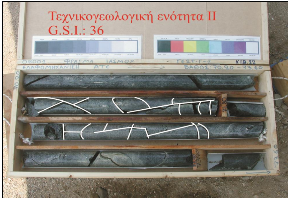
Σχήμα 26: Δείγμα της ποιότητας της βραχώμαζας για την τεχνικογεωλογική ενότητα II.
