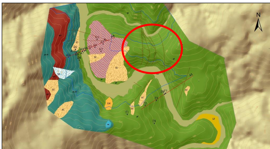
Σχήμα 2: Γεωλογικός χάρτης της περιοχής του Ιάσμου με έμφαση στην περιοχή του αυχένα (Κλίμακα: 1:51.000). Απεικονίζονται οι γεωλογικοί σχηματισμοί, οι δύο πιθανοί άξονες φράγματος Α0-Α1, με έμφαση στον άξονα Α1, τα γειτονικά πετρώματα, οι εγκάρσιοι άξονες και οι ερευνητικές γεωτρήσεις. RD: αποθέσεις κόιτης, EL: ελουβιακός μανδύας, RF: ογκόλιθοι γενεσίων, SC: πλευρικά κορήματα, LM: υλικά διάβρωσης και παλαιών κατολισθήσεων, LT: παραποτάμιες αποθέσεις, gn.ab: αμφιβολιτικός γενεύσιος, orh: οφειόλιθος, mr: μάρμαρα, gd: μεταγρανодиορίτης. (Τροποποιημένος χάρτης από: Αλεξιάδου, 2008).
