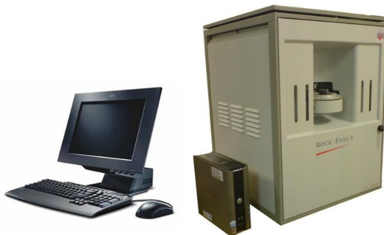
Φωτ.1: Αναλυτής Rock-Eval 6 από την εταιρεία Vinci Technologies (10)
