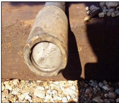
Σχήμα 32 - Θραυσμένος Άξονας Αντλίας
