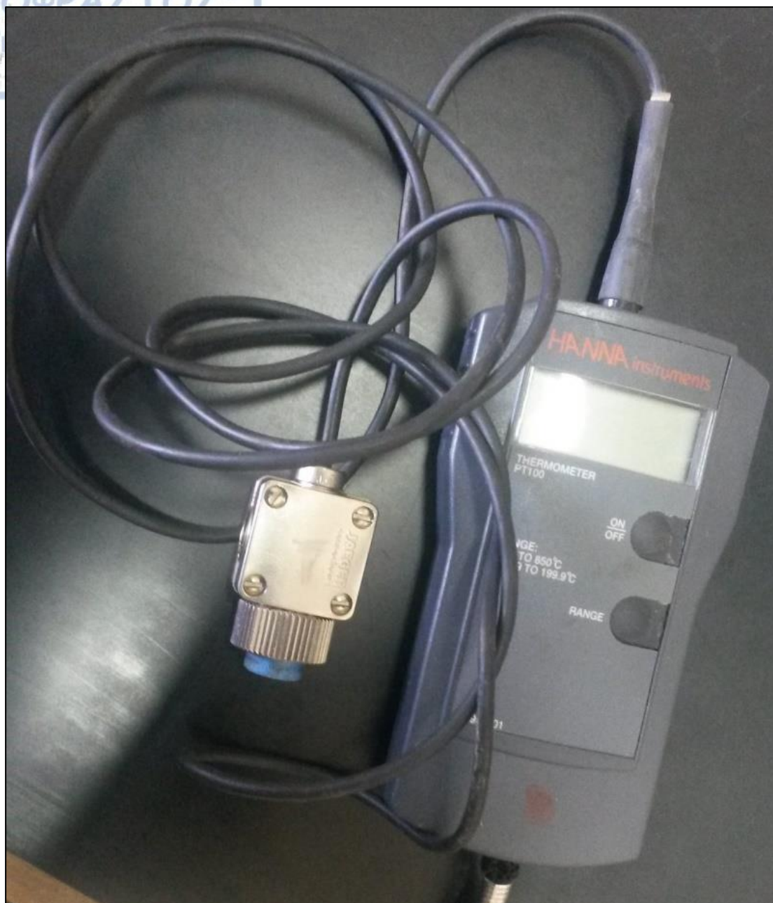
Σχήμα Π5.1.3 - Θερμόμετρο Pt100 της HANNA Instruments ( http://hannainst.com/hi955501-4-wire-pt100-thermometer.html )
