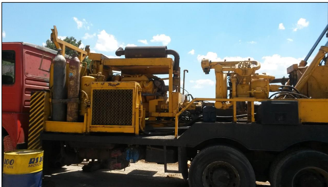
Σχήμα 13 – Γενική άποψη των μηχανικών μερών του υδραυλικού γεωτρυπάνου. Διακρίνονται ο κινητήρας ισχύος (αριστερά) και η διάταξη της αντλίας επανακυκλοφορίας του πολτού (δεξιά)
