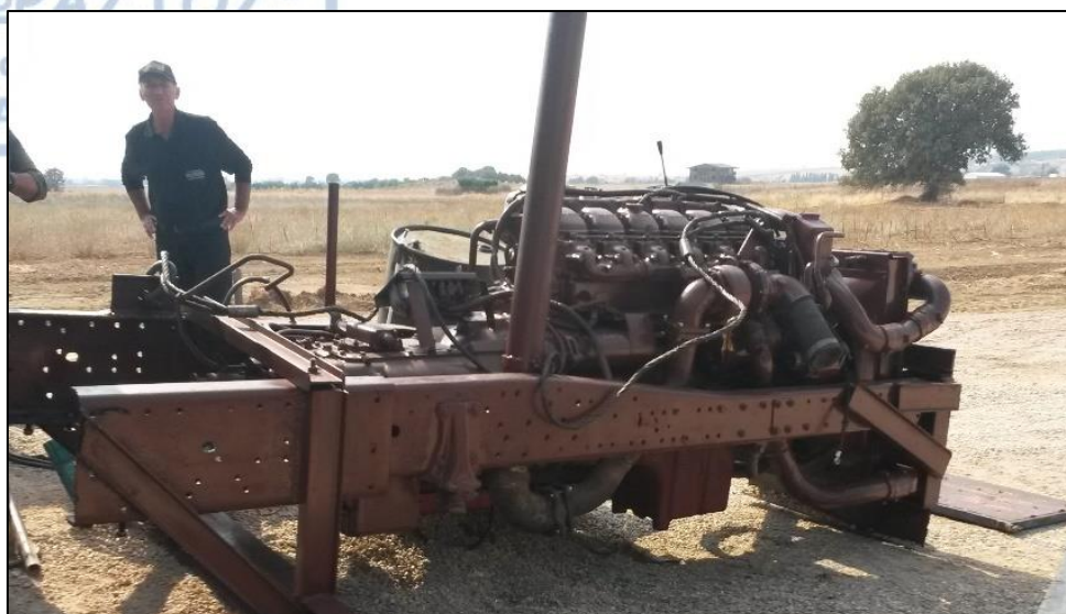
Σχήμα 28 - Ντιζελοκινητήρας ισχύος 200HP
