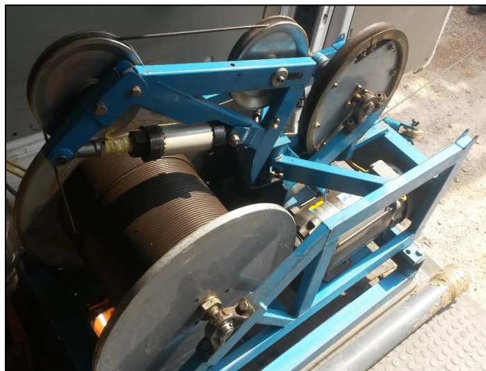
Σχήμα 22 - Μηχανοκίνητο Βαρούλκο Καθέλκυσης Ευαίσθητων Κεφαλών
