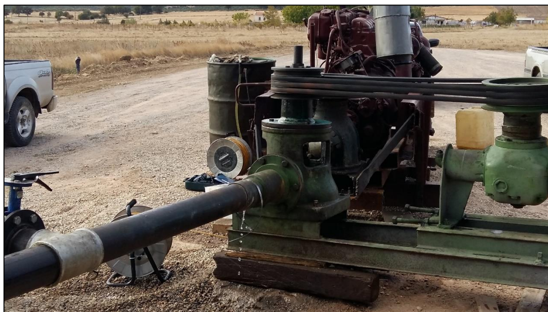
Σχήμα 27 – Κεφαλή του προσωρινού αντλητικού συγκροτήματος κατά την άντληση
