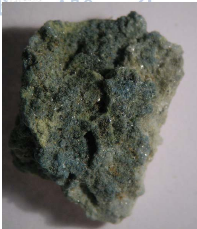
Εικ 7.2.1.4: Γιαροσίτης στο στερεοσκόπιο μαζί με κόκκους χαλαζία και μοσχοβίτη
