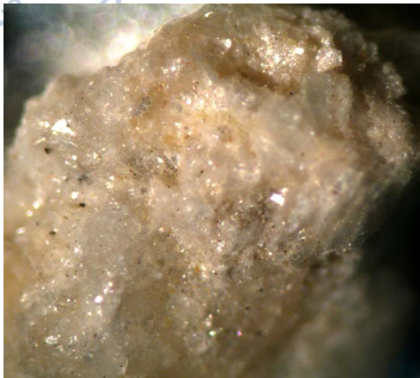
Εικ. 7.5.1.1.: Στερεοσκοπική εικόνα με κρυστάλλους χαλαζία και μοσχοβίτη
