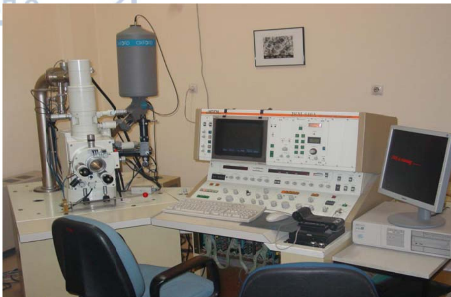
Εικ 7.2 Ηλεκτρονικό μικροσκόπιο σάρωσης (SEM) Τομέας Ορυκτολογίας Πετρολογίας ΑΠΘ
