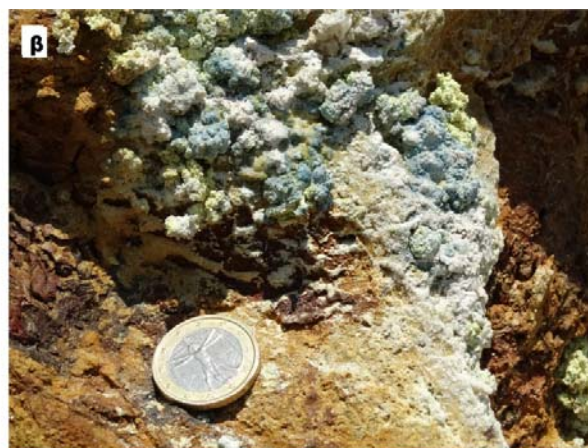
Εικ 6.1.4 α) Θέση δειγματοληψίας δείγματος 2.1 και β) Δείγμα 2.1 με επανθίσματα θείου σε μεγαλύτερη λεπτομέρεια . Περιοχή ρέματος Αργυρώς.
