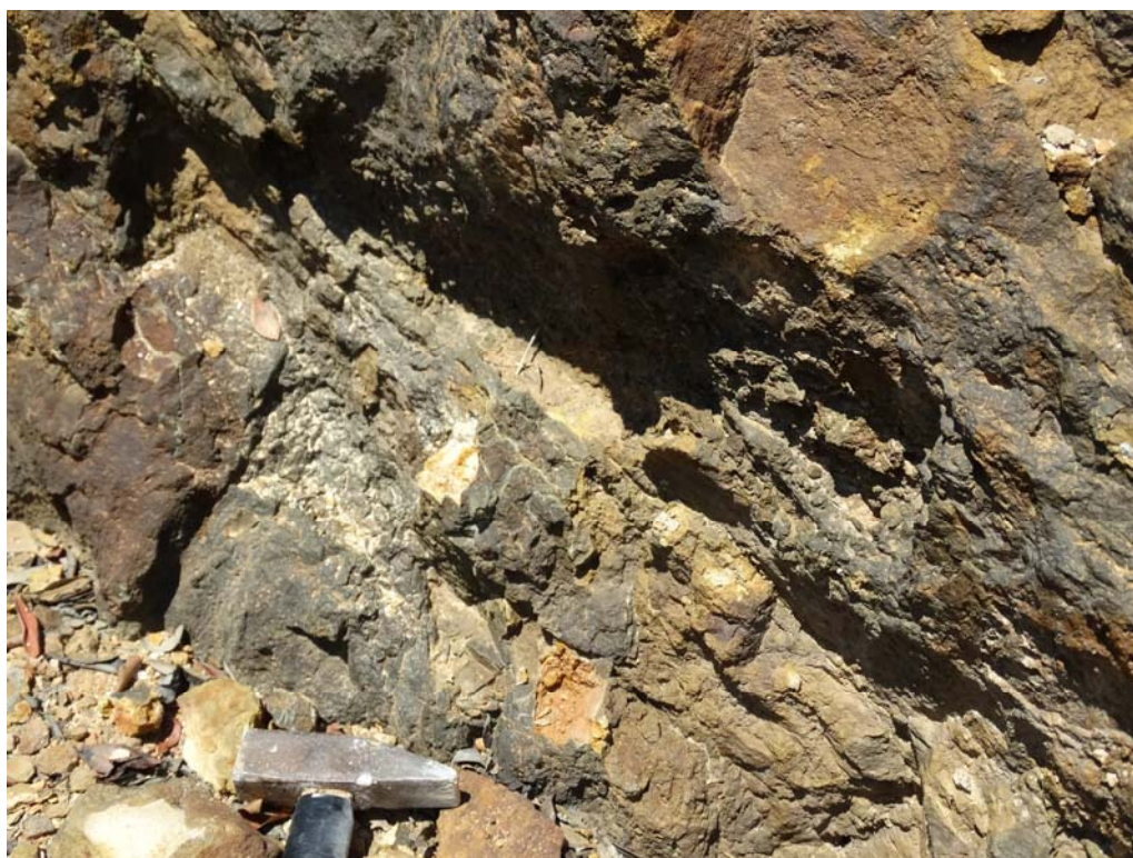
Εικ. 6.1.7 Θέση δειγματοληψίας δείγματος 4, οξειδωμένο πέτρωμα με επανθίσματα Mn. Περιοχή ρέματος Αργυρώς
