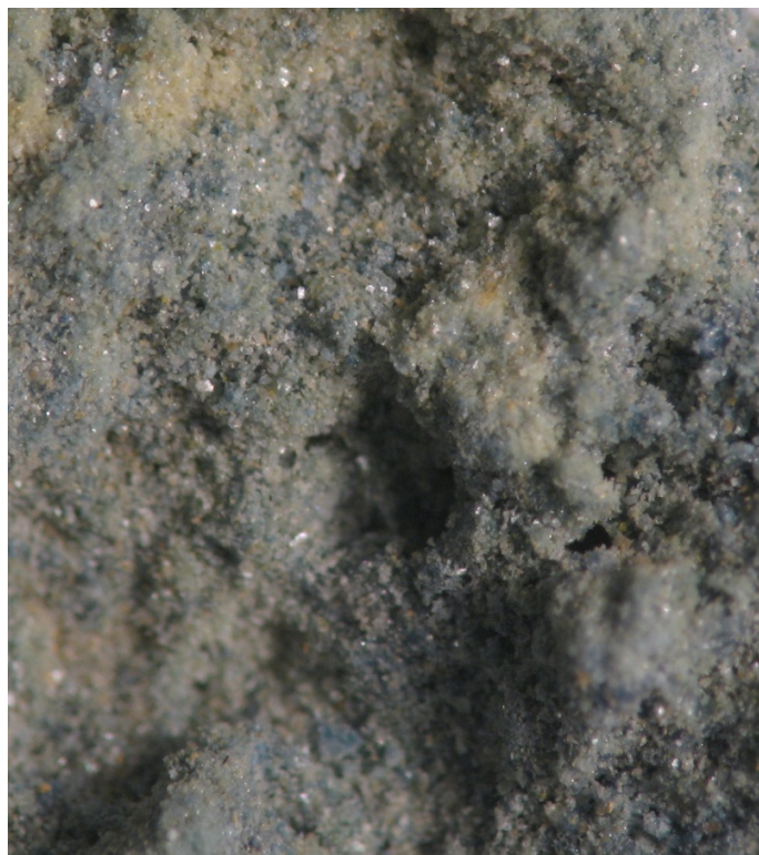
Εικ 7.2.1.4: Γιαροσίτης στο στερεοσκόπιο μαζί με κόκκους χαλαζία και μοσχοβίτη
