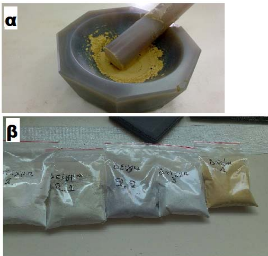
Εικ 6.2.1 α) Κονιορτοποίηση σε αχάτινο γουδί β) Κονιορτοποιημένα δείγματα τοποθετημένα μέσα σε σακουλάκια
