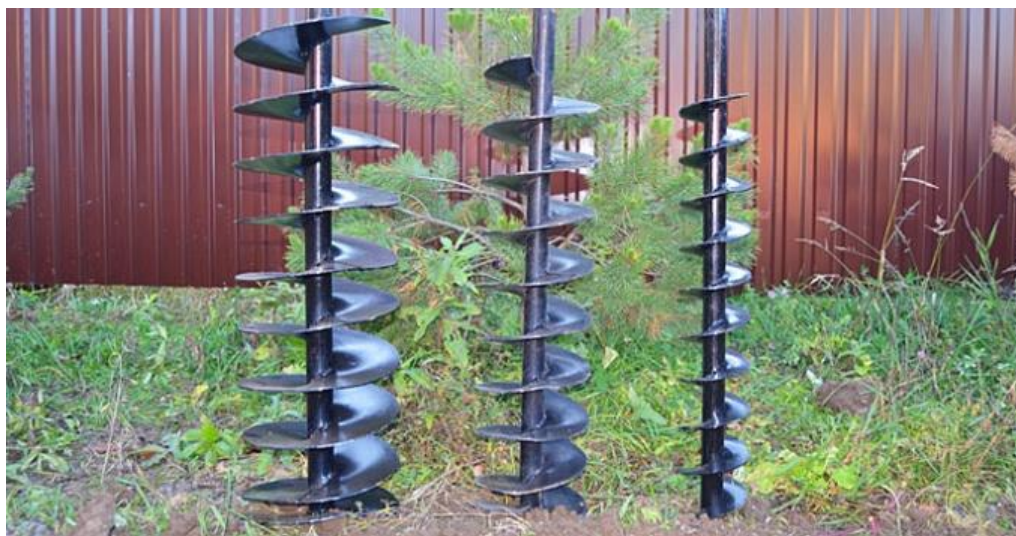
Εικ.1: Τύποι τρυπανιών για ελικοειδή διάτρηση: Στο εξωτερικό μέρος παρατηρείται το χαρακτηριστικό σπирάλ (Πηγή: http://bulldaily.com/el/pages/1639370 )
