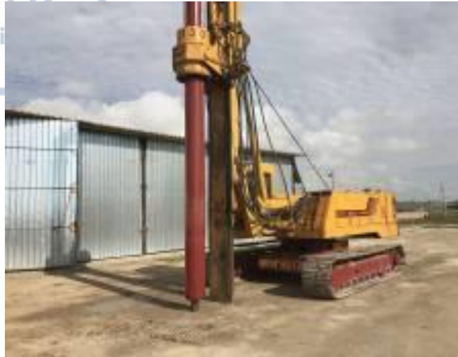
Εικ.3: Μορφή περιστροφικού γεωτρύπανου (Πηγή: http://www.baupool.gr )
