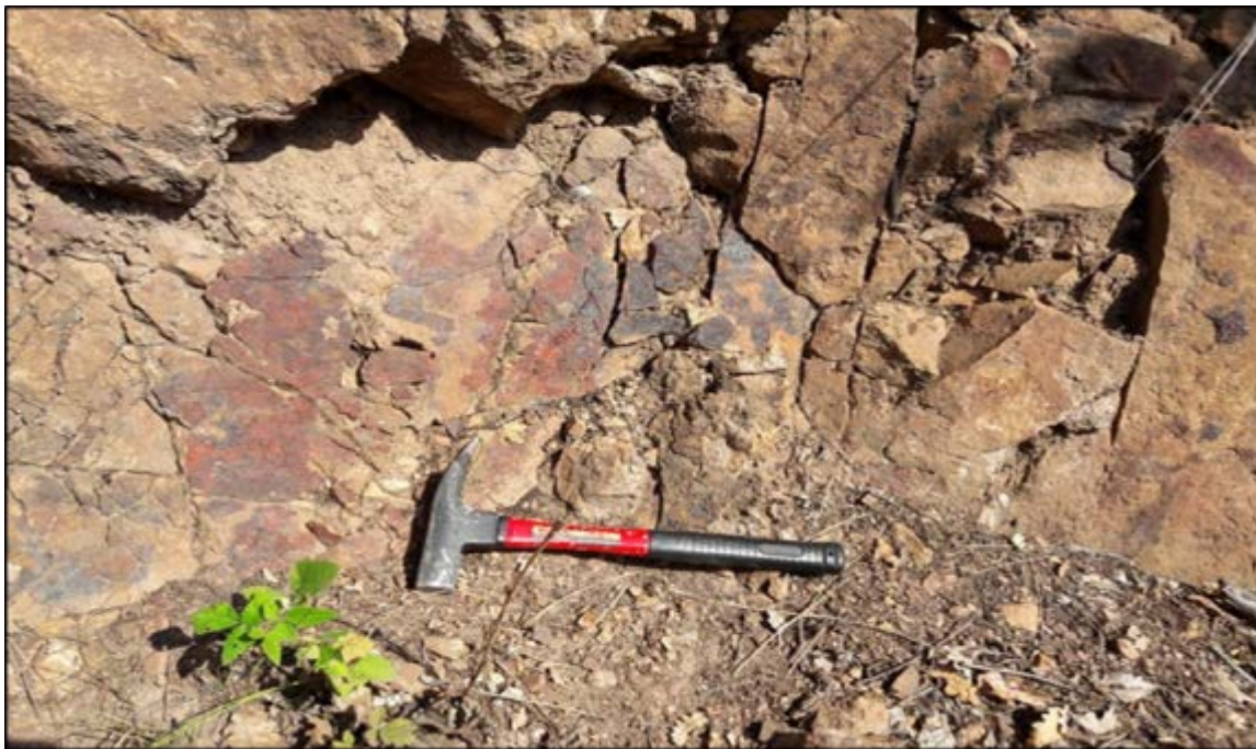
Εικόνα 4.8: Φωτογραφία από οξειδωμένες συγκεντρώσεις σιδηροπυρίτη που μετατράπηκαν σε λειμωνίτη, στην περιοχή κοντά στον οικισμό Κορυφής.
