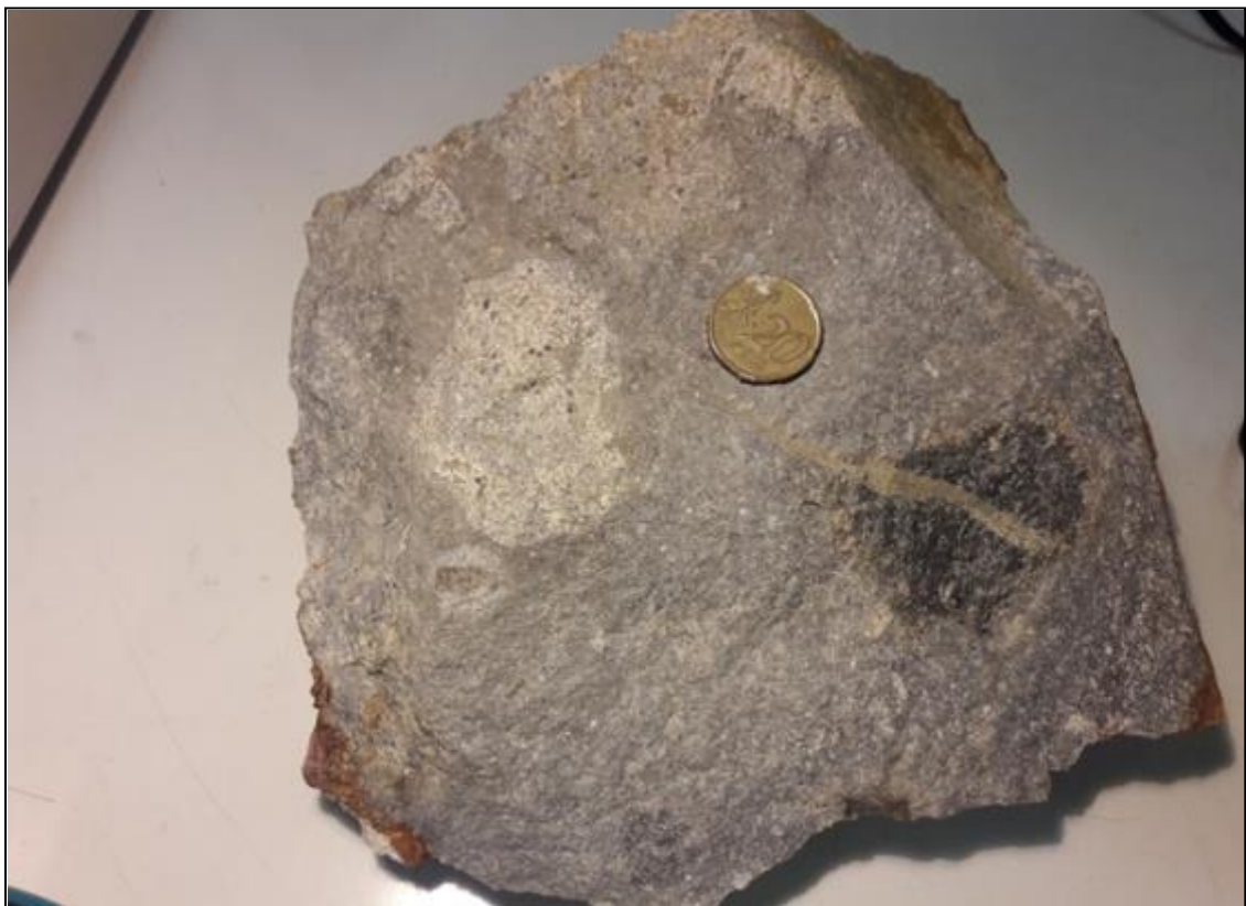
Εικόνα 4.4: Φωτογραφία από δείγμα του γκρί πορφύρη της περιοχής μελέτης. Εμφανίζεται με εγκλείσματα γενεύσιου (σκούρο χρώμα δεξιά) και πορφύρη (ανοικτό χρώμα αριστερά) (porphyry breccia).
