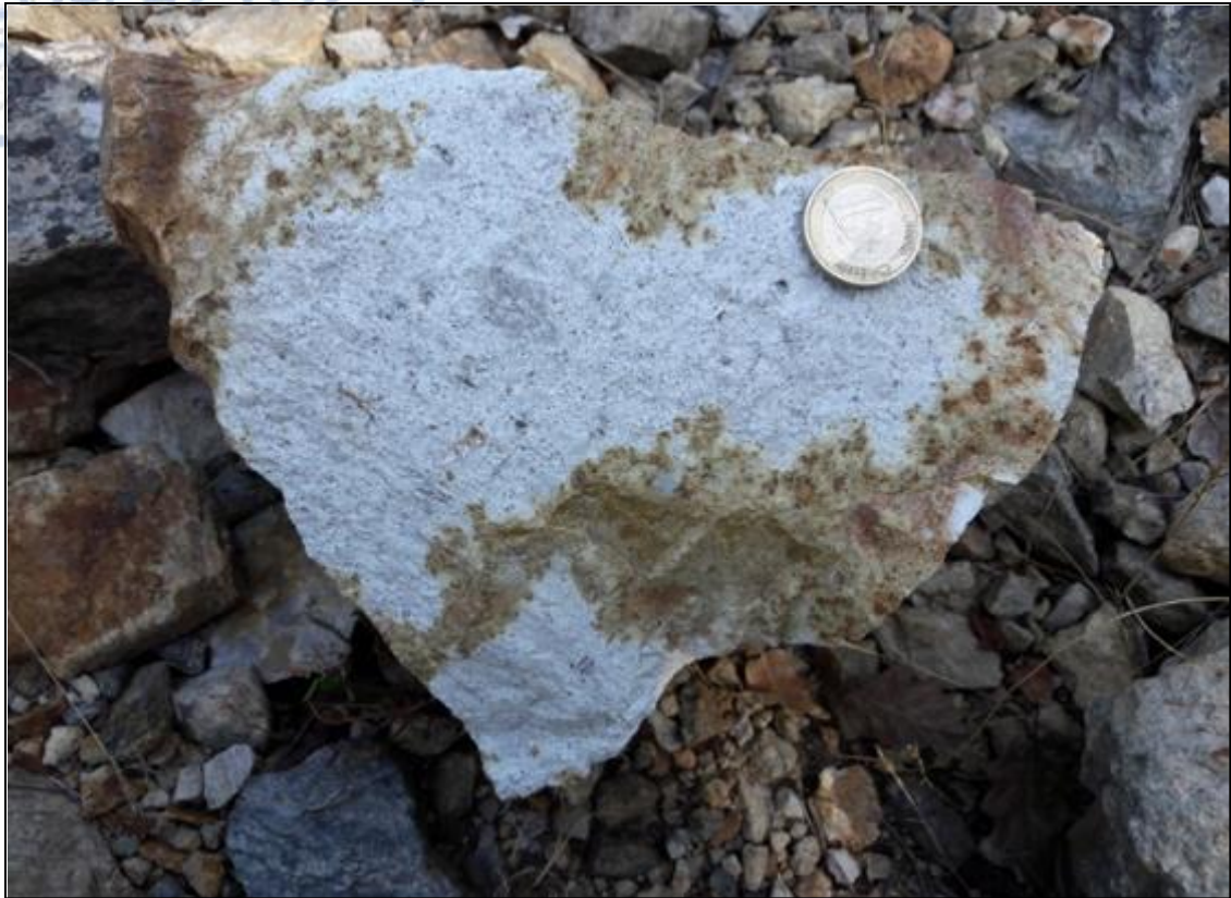
Εικόνα 4.3 Φωτογραφία από δείγμα του πορφύρη με λευκό χρώμα, λόγω έντονης αργιλοποίησης.
