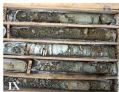
Τύπος IX. Αποδιοργανωμένη – Κατακερματισμένη βραχώμαζα
