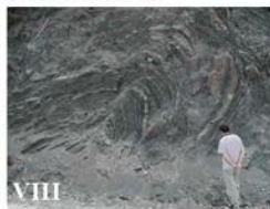
Τύπος VIII. Έντονα διαταραγμένη – πτυχωμένη βραχώμαζα η οποία διατηρεί τη δομή της και δεν έχει παραμορφωθεί – διατηρεί σε μεγάλο βαθμό και αποτελείται κυρίως από ιλιούθου με ενστρώσεις ψαμμίτη
