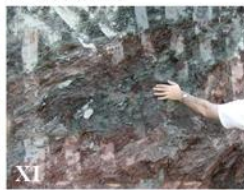
Τύπος XI. Τεκτονικώς έντονα διατηρημένος ιλιούθος ή αργιλικός σχιστόλιθος σε χαστική δομή με θύλακες αργίλου
