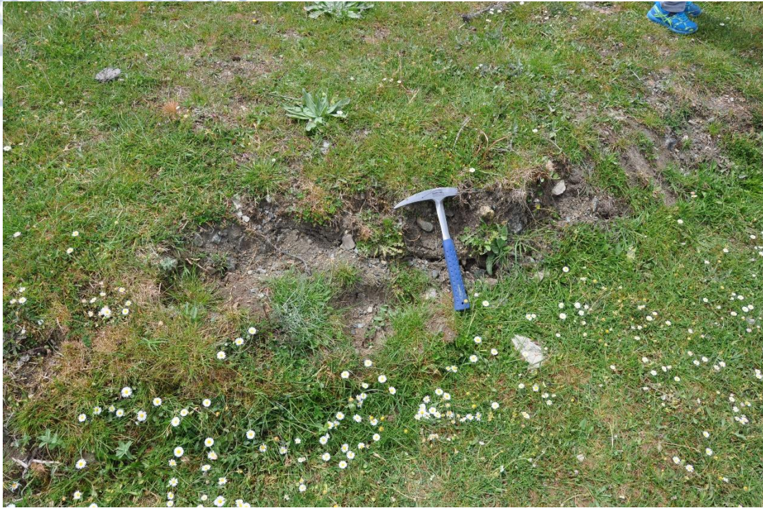
Εικόνα 7.18 Διάρρηξη στο φρύδι της κατολίσθησης Ls_Per1 όπως αποτυπώθηκε τον Μάιο 2017.
