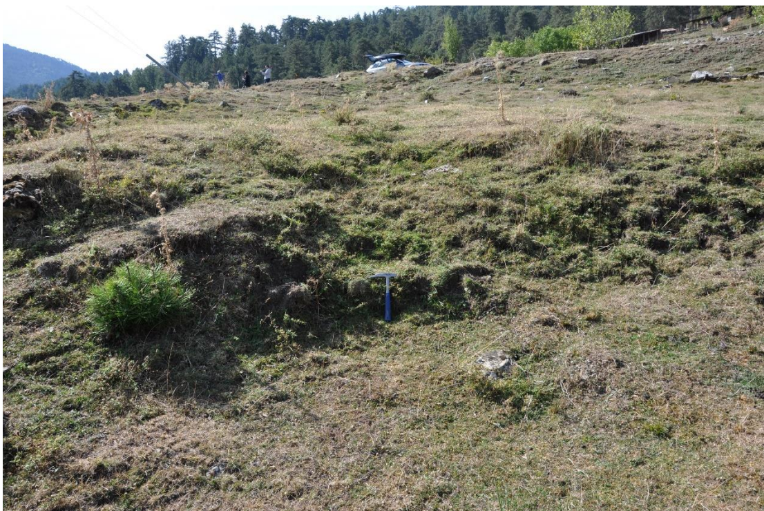
Εικόνα 7.3 Εξάρσεις του αναγλύφου, σημάδι ύπαρξης κατολίθησης.
