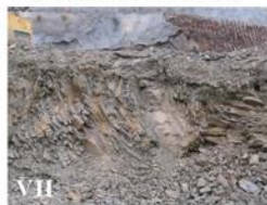
Τύπος VII. Έντονα διαταραγμένη – πτυχωμένη βραχώμαζα η οποία διατηρεί τη δομή της και αποτελείται από εναλλαγές ψαμμίτη – ιλιούθου σε ίσες αναλογίες
