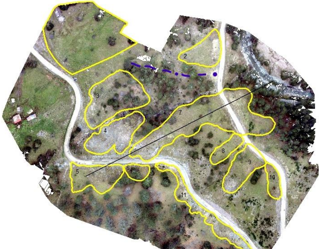
Εικόνα 7.16 Η οριοθέτηση και χαρτογράφηση των κατολισθήσεων όπως αυτές προέκυψαν από την παρούσα μελέτη. Με κίτρινο προσδιορίζονται τα όρια της εκάστοτε κατολίσθησης. Με μπλε κουκίδες σημειώνονται οι εμφανίσεις του ασβεστόλιθου, ενώ με διακεκομμένη γραμμή η σταθερή ράχη που δημιουργείται.
