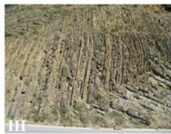
Τύπος III. Μέτρια διαταραγμένος ψαμμίτης με ενστρώσεις ιλιούθου
