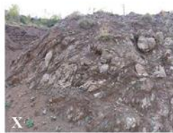
Τύπος X. Τεκτονικά παραμορφωμένος, έντονα πτυχωμένος, ρηγματωμένος ιλιούθος ή αργιλικός σχιστόλιθος με κερματισμένα και παραμορφωμένα ψαμμικά τεμάχια τα οποία διαμορφώνουν σχεδόν χαστική δομή
