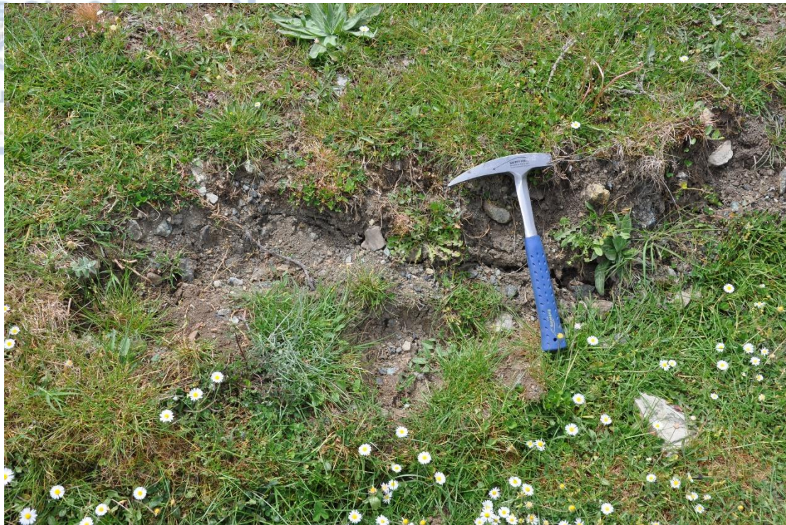
Εικόνα 7.4 Επιφανειακή διάρρηξη, σημάδι ύπαρξης και ενεργότητας κατολίσθησης.
