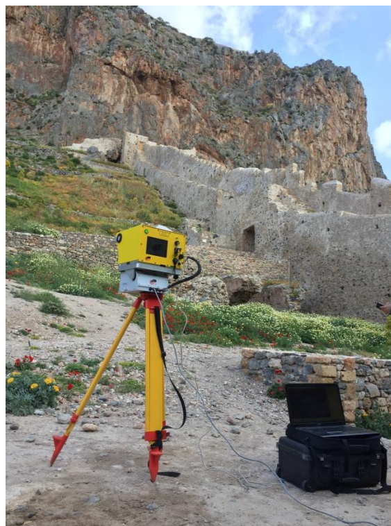
Εικόνα 5.1. Ο σαρωτής 3-D ILRIS Laser Scanner της Ortech κατά τη διαδικασία σάρωσης του βράχου της Μονεμβασίας
