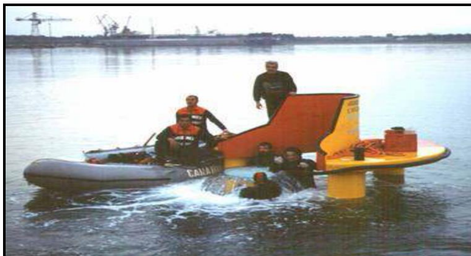
Εικόνα 23 Πειραματική εκμετάλλευση στην υποθαλάσσια πηγή της «Citro Galeso» στο Mar Piccolo του Ταράντο (Ν. Ιταλία). Ένας σωλήνας διαμέτρου 1 m φθάνει στην επιφάνεια της θάλασσας και βρίσκεται υπό την κατοχή μιας ημι-βυθισμένης σημαδούρας ( postgrad.hydro.ntua.gr ).
