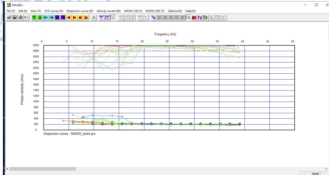
Σχήμα 2-22 Καμπύλες διασποράς όπως παρουσιάζονται στο πρόγραμμα WaveEq (συνεχόμενες γραμμές). Με διακεκομμένες γραμμές συμβολίζεται η μεταβολή του συντελεστή διασυσχέτισης για κάθε καμπύλη διασποράς (λογισμικό Seisimager, Geometrics)
