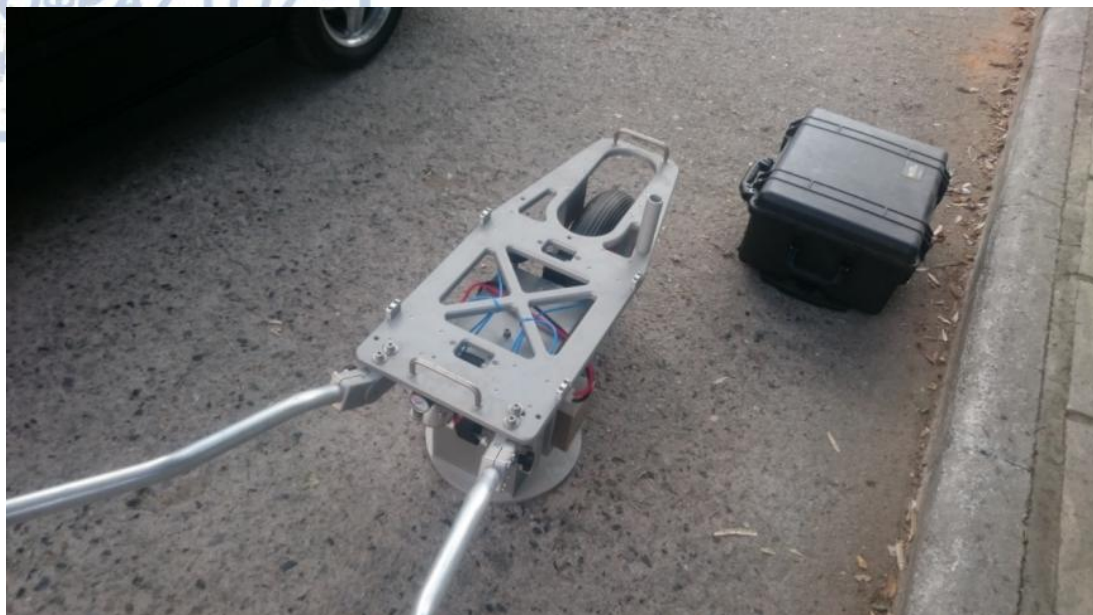
Σχήμα 2-33 Πηγή EIViS III P8. Διακρίνονται το υδραυλικό σύστημα δονήσεων στη διάταξη με τον τροχό και η θήκη με τις μπαταρίες.
