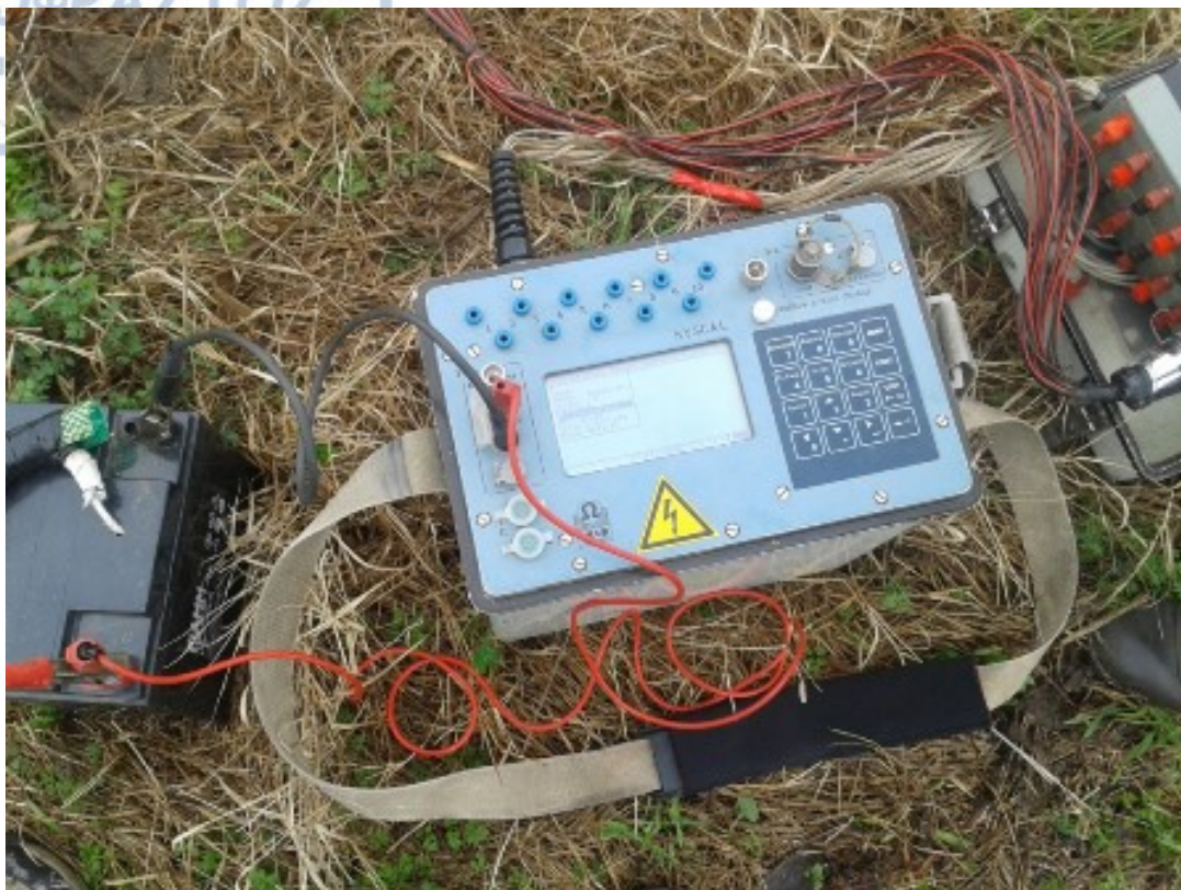
Σχήμα 2-1 Όργανο μέτρησης ειδικής ηλεκτρικής αντίστασης Syscal Pro και πολύκλινα καλώδια που χρησιμοποιήθηκαν στη συλλογή των μετρήσεων.
