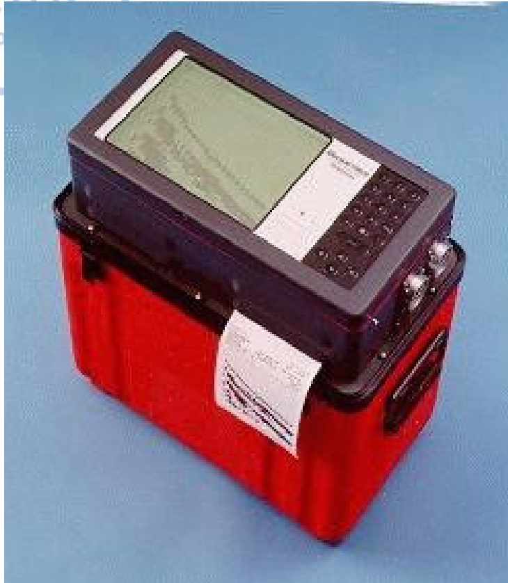
Σχήμα 2-15 Φορητός σειсмоγράφος StrataView 48 καναλιών της εταιρείας Geometrics, ο οποίος χρησιμοποιήθηκε για τη λήψη των μετρήσεων.
