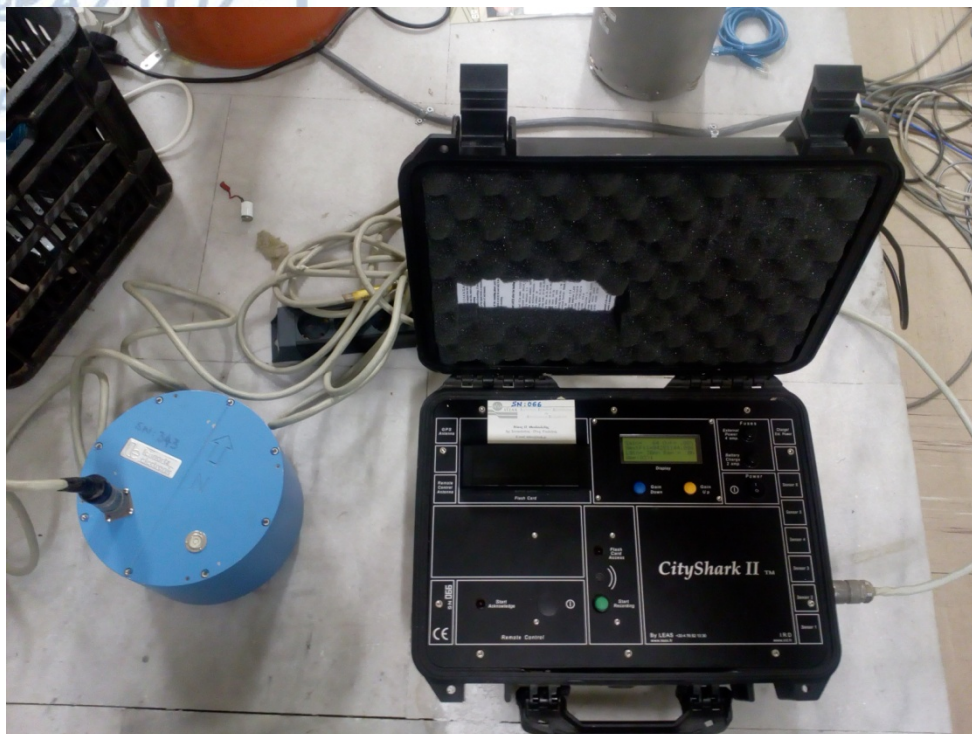
Σχ. 2.4. Όργανα καταγραφής εδαφικού θορύβου Lennart Le-3D/5s & Cityshark II.
