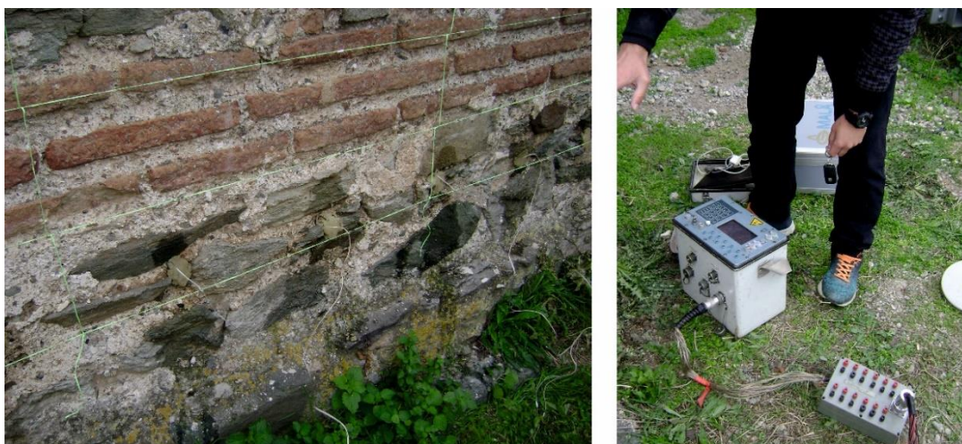
Σχήμα 5.11 Αριστερά συλλογή δεδομένων (επαφή με μπεντονίτη), δεξιά όργανο μέτρησης Syscal Pro.
