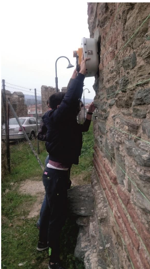
Σχήμα 5.3 Αριστερά συλλογή δεδομένων με την κεραία 500MHz της MALA, δεξιά κεραία των 250 MHz.
