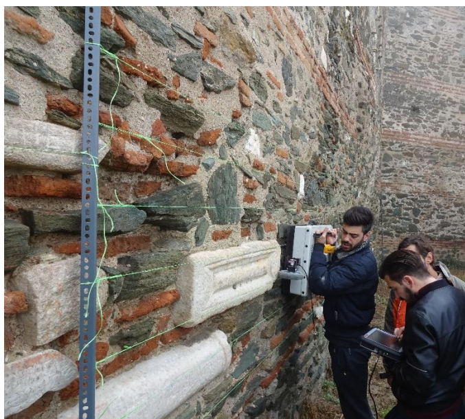
Σχήμα 5.20 Συλλογή δεδομένων με την κεραία 250MHz της MALA.
