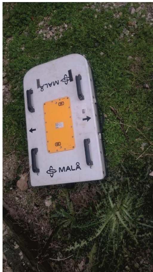
Σχήμα 5.3 Αριστερά συλλογή δεδομένων με την κεραία 500MHz της MALA, δεξιά κεραία των 250 MHz.
