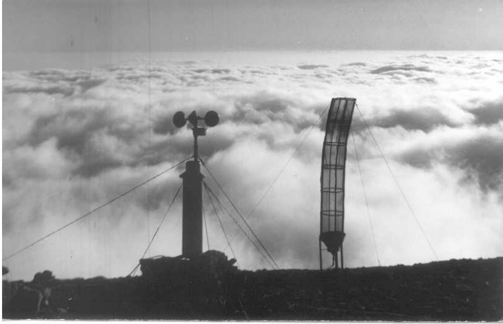
Σχήμα 1.12. Συλλογέας ομίχλης Grunow ύψους 3μ (δεξιά) και βροχόμετρο με ανεμόμετρο (αριστερά) (ΕΚΟ, ΑΠΘ)
