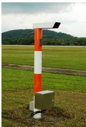
Σχήμα 1.7. Ορατόμετρο (Πηγή: https://en.wikipedia.org/wiki/Runway_visual_range )
