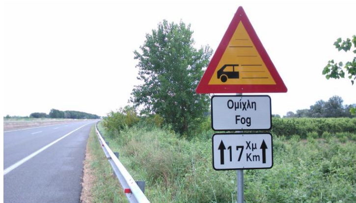
Σχήμα 1.8. Πινακίδα ένδειξης αρχής τμήματος που εμφανίζεται ομίχλη και το πιθανό μήκος εμφάνισης (πηγή: www.egnatia.eu/files/pdf/Fog_Signage_GR.pdf )
