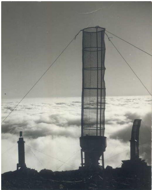
Σχήμα 1.11. Συλλογέας ομίχλης Grunow ύψους 3μ. (ΕΚΟ, ΑΠΘ)
