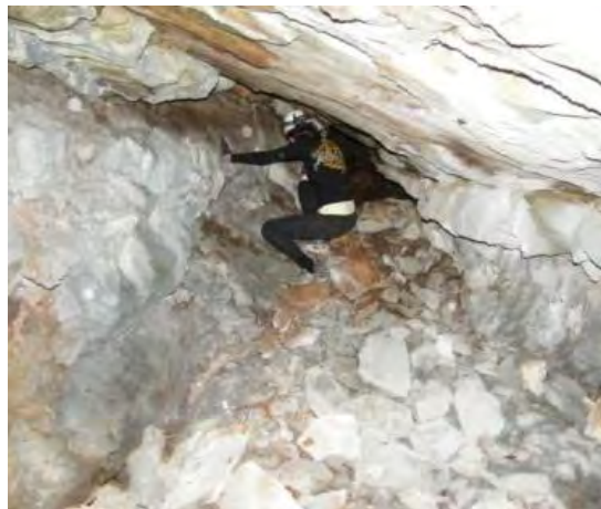
Εικόνα 8.5.4.1. Αριστερά: Άποψη της εισόδου του της υπόγειας στοάς «Τρίκορφο-1». Σημειώνεται κανονικό ρήγμα. Δεξιά: Άποψη του εσωτερικού της στοάς. Στα τοιχώματα της οροφής διακρίνεται ίχνος από την οξειδωμένη μεταλλοφορία που έχει εξορυχθεί.
