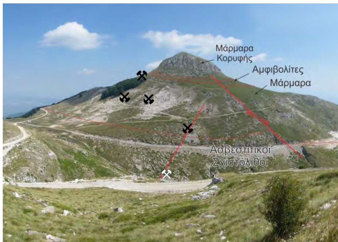
Εικόνα 8.4.2.1 Αποψη προς ανατολάς της κορυφής Αβγού. Οι είσοδοι υπόγειων εργασιών και τεκτονικές ασυνέχειες στην περιοχή του Αβγού. Με λευκό χρώμα σημειώνεται το σύγχρονο μεταλλείο του «Αβγού» και με μαύρο τα παλαιότερα. Με ανεστραμμένο σύμβολο απεικονίζεται κατεστραμμένη είσοδος μεταλλείου. Διακρίνονται με κόκκινη γραμμή τα ρήγματα και με στικτή οι επαφές των λιθολογικών σχηματισμών.
