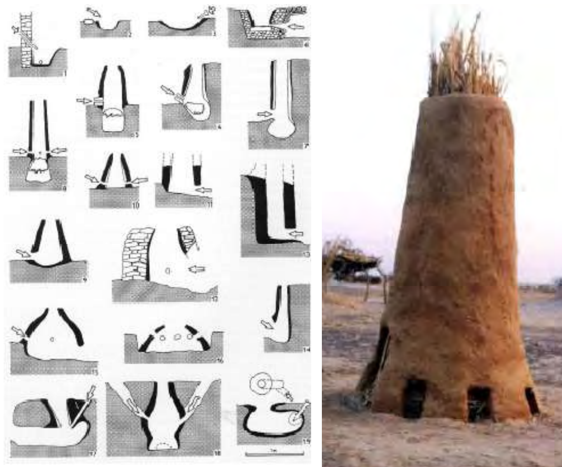
Εικόνα 3.8.6.3 Διάφοροι τύποι καμίνων μεταλλουργίας του σιδήρου (Pleiner, 2000).
