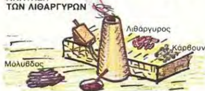
Εικόνα 3.8.5.1 Η αλυσίδα παραγωγής αργύρου και μολύβδου στο αρχαίο Λαύριο (Κονοφάγος, 1980).
