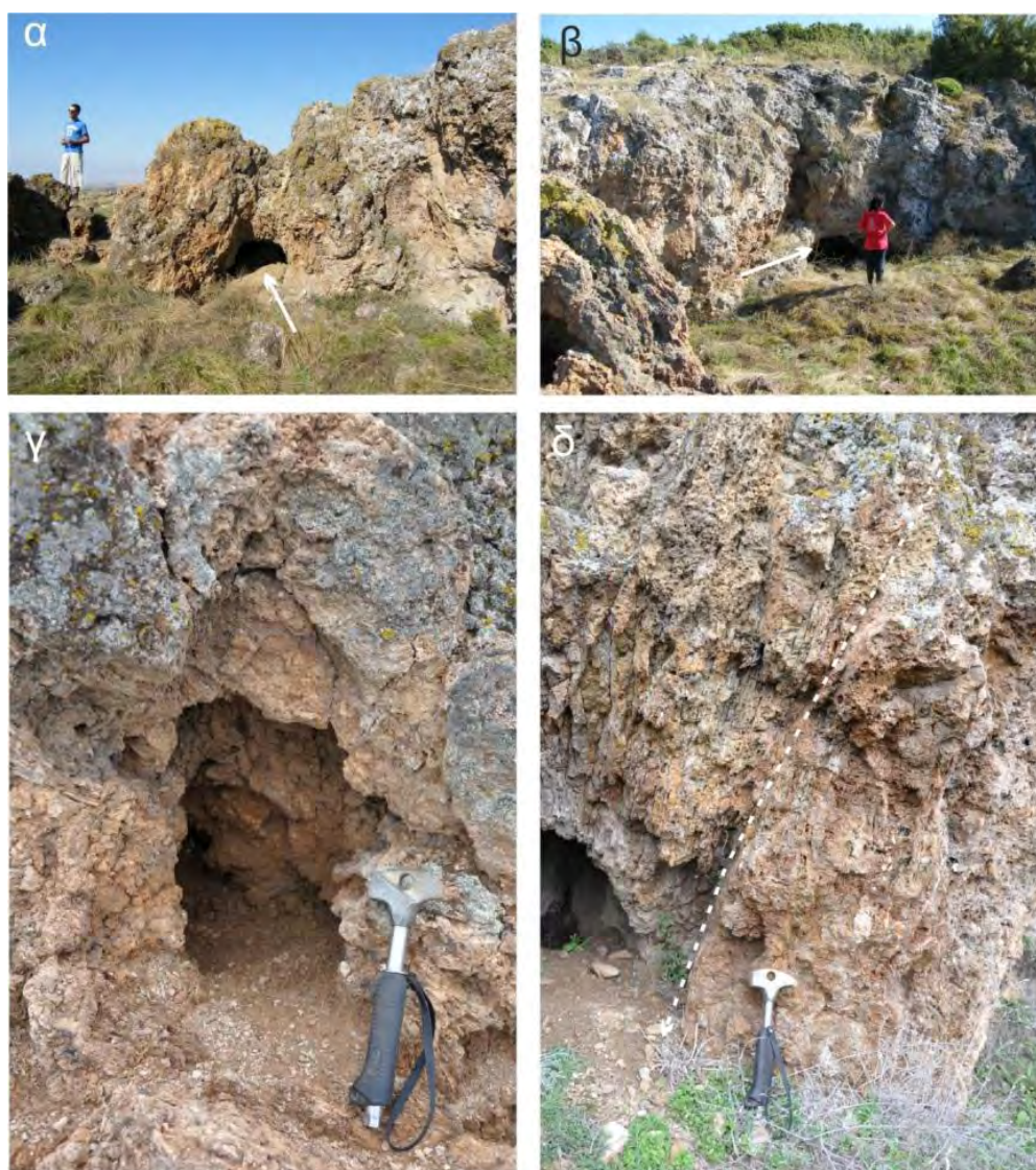
Εικόνα 8.8.1.2.3 α) Άποψη από την είσοδο της υπόγειας στοάς (σημειώνεται με βέλος). β) Άποψη από την εκβάθυνση στο ανατολικό πρανάς (σημειώνεται με βέλος). γ) Φωλιά μεταλλεύματος πλήρως εξορυγμένη. δ) Μεταλλοφορία βαρύτερη και σιδηροξειδίων κατά μήκος τεκτονικής επιφάνειας.
