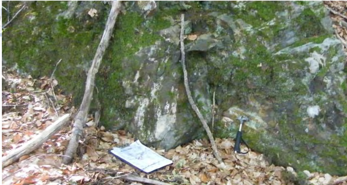
Εικόνα 8.3.2.1 Οξειδωμένη μεταλλοφορία σε ρηξιγενή επιφάνεια εξωτερικά της μεταλλευτικής στοάς Μαυροκορφή-1.
