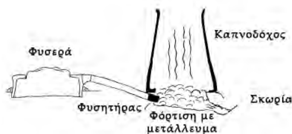
Εικόνα 3.8.2.5 Μεταλλουργική καμίνος χαλκού από το Χρυσοκάμινο στην Κρήτη (τροπ. από Betancourt, 2006).
