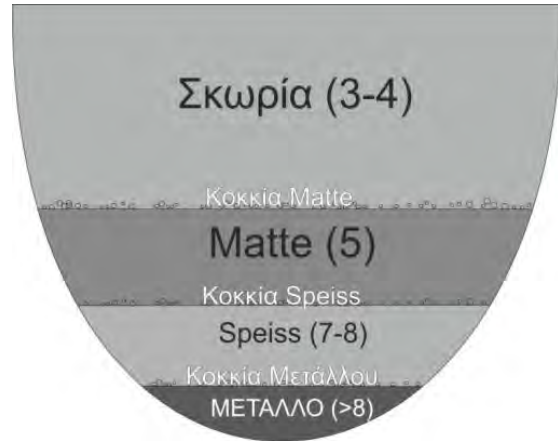
Εικόνα 3.9.2.1 Διαστρωμάτωση στο εσωτερικό της μεταλλουργικής καμίνου με τα ειδικά βάρη των επιμέρους στρωμάτων σε παρένθεση (Τροποποιημένο από Tylecote et al, 1997).
