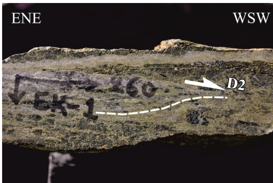
Φωτ. 25. Μεσοσκοπικής κλίμακας δομές παραμόρφωσης (S-C) της φάσης D2, σε πρασινοσχιστόλιθους της ηφαιστειοϊζηματογενούς σειράς Λιβαδιών του δυτικού Πάικου (δείγμα χειρός, XZ- τομή). Διακρίνεται η φορά διάτμησης προς τα ΔΝΔ (από Katrivanos et al. 2013 ).
