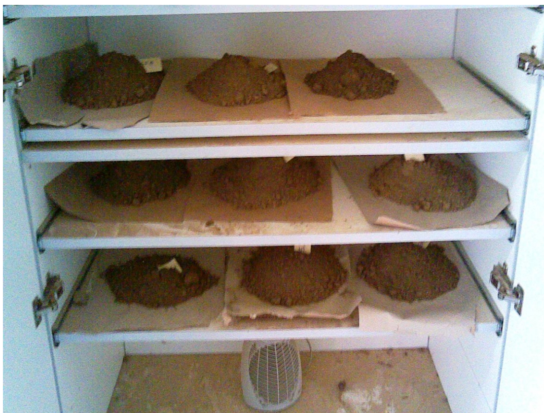
Εικόνα 3.6- Ξήρανση των δειγμάτων εδάφους σε θερμοκρασία δωματίου.
