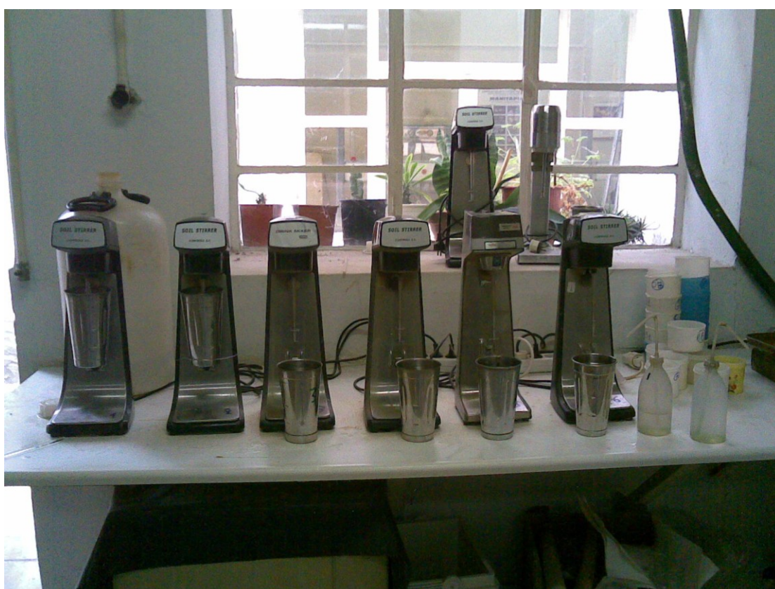
Εικόνα 3.9- Ανάμειξη δειγμάτων με μίξερ.
