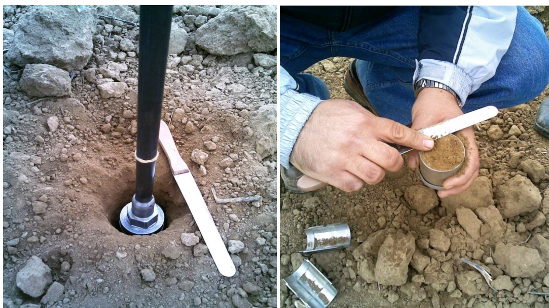
Εικόνα 3.5- Δειγματοληψία αδιατάρακτων δειγμάτων και δείγματα εδάφους.
