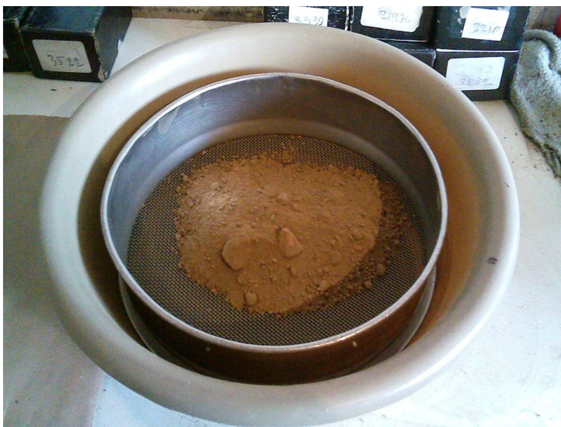
Εικόνα 3.7- Κοσκίνισμα δειγμάτων εδάφους με κόσκινο 2χιλιοστών.
