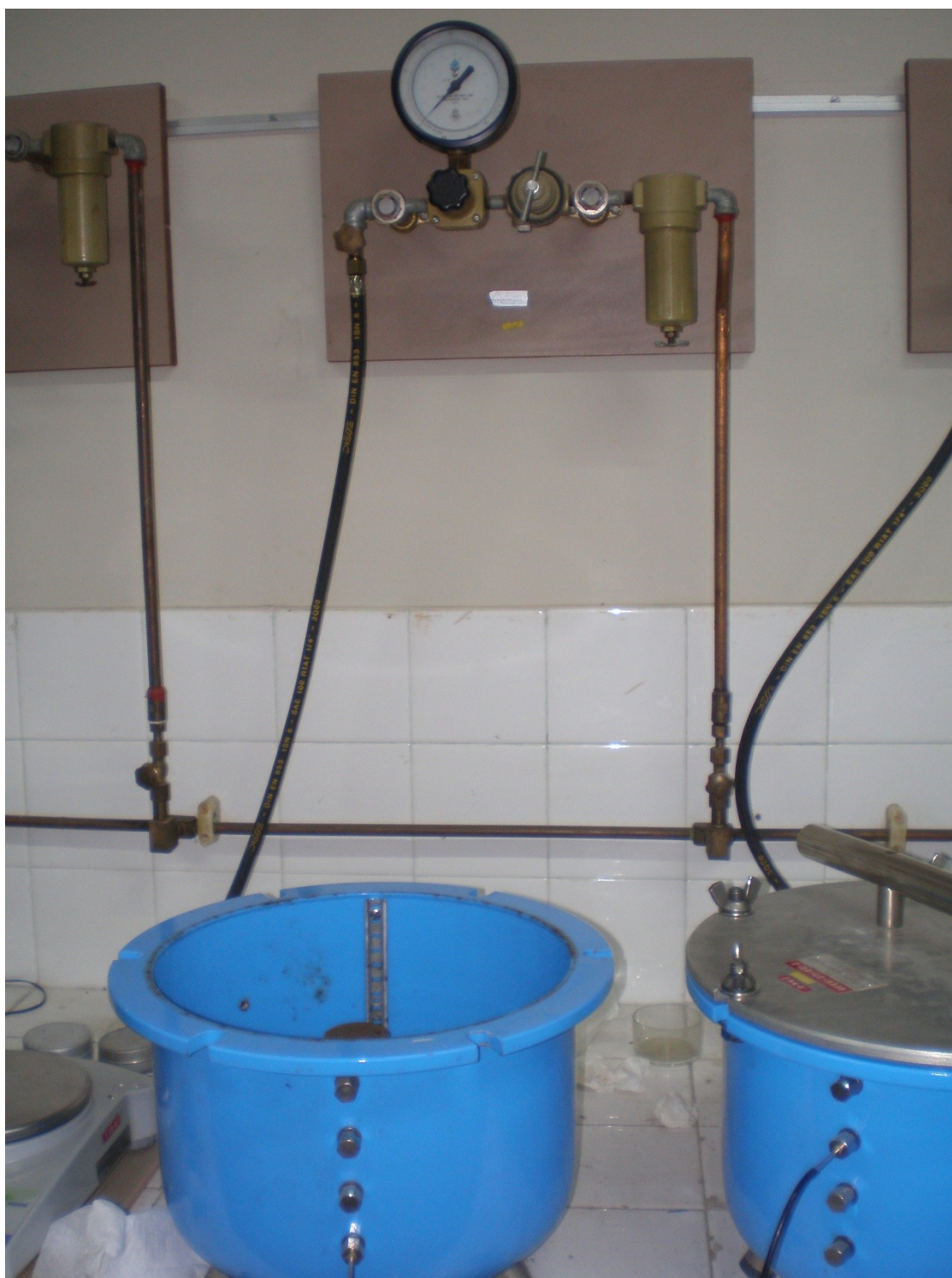
Εικόνα 3.16- Συσκευή μεμβράνη πίεσεως.
