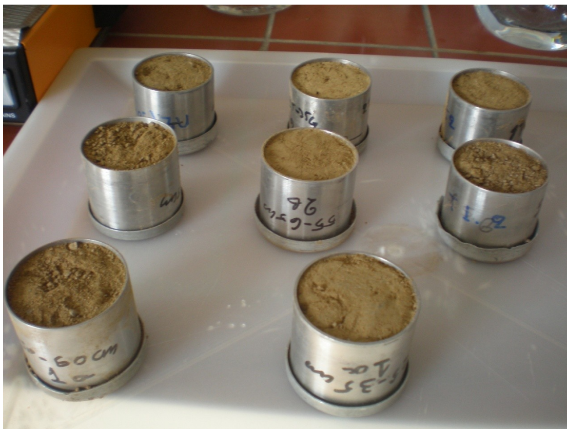
Εικόνα 3.12- Αδιατάρακτα δείγματα μετά την αφαίρεση εδάφους πάχους 2 χιλιοστών.
