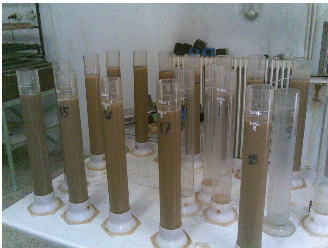
Εικόνα 3.10- Δείγματα εδάφους σε ογκομετρικούς κυλίνδρους.
