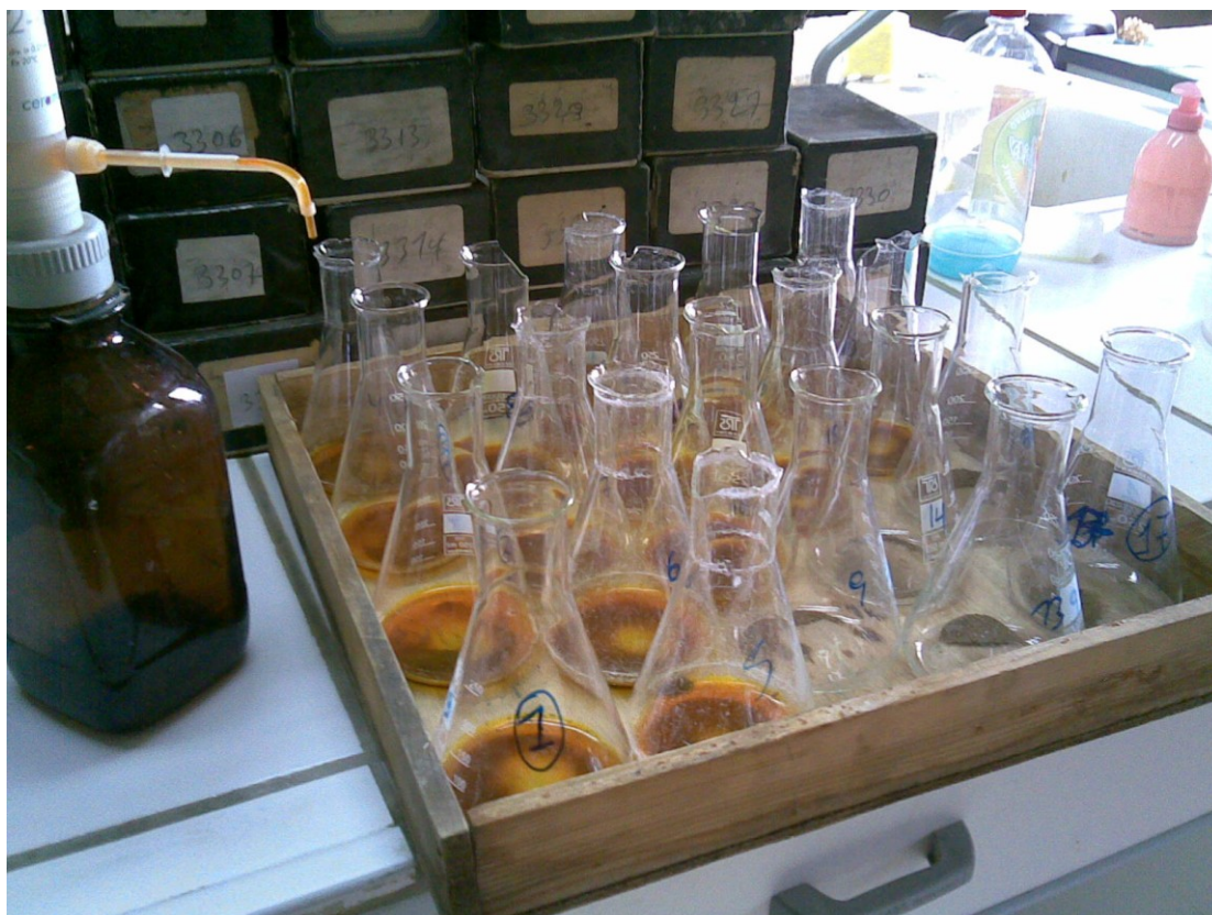
Εικόνα 3.8- Παρασκευή πάστας για τον προσδιορισμό της μηχανικής σύστασης
