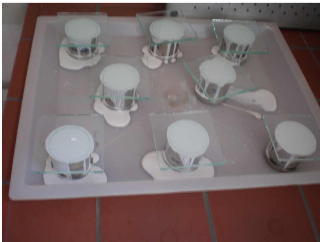
Εικόνα 3.14- Τοποθέτηση γύψου στα αδιατάρακτα δείγματα.
