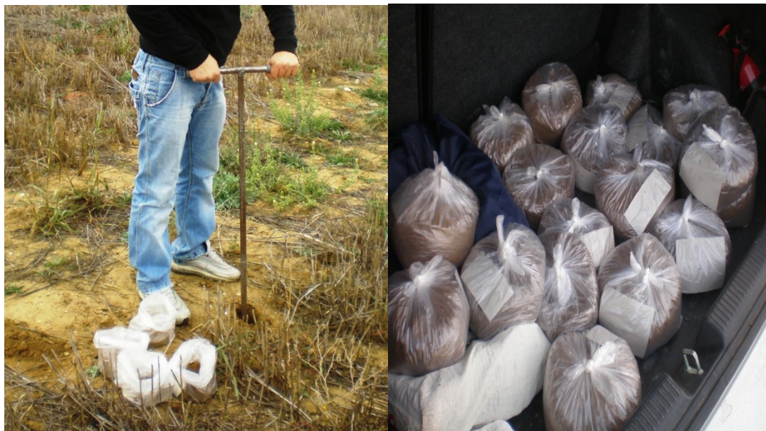
Εικόνα 3.4- Δειγματοληψία με δειγματολήπτη Edelman και δείγματα εδάφους.
