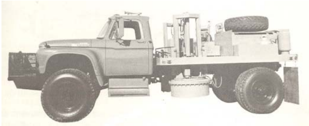
Σχήμα : Σύγχρονη διάταξη, Dinoseis, σε αυτοκινούμενο όχημα
