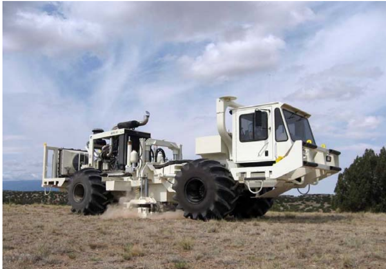
Σχήμα : Σύγχρονη διάταξη, Vibroseis, σε αυτοκινούμενο όχημα
