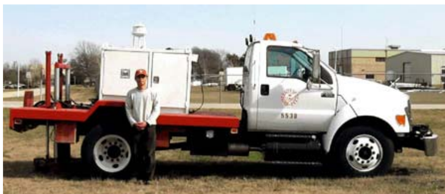
Σχήμα : Σύγχρονη διάταξη σεισμικής πηγής Thumper , σε αυτοκινούμενο όχημα. ( http://www.google.gr/imgres?q=thumper+seismic+source&hl=el&gbv=2&tbn=isch&tbnid=9xX3emO6Fp10SM:&imgrefurl=http://hvo.wr.usgs.gov/volcanowatch/2008/08_01_03.html&docid=Rcq8JecKBg8Z6M&w=450&h=193&ei=dBg4TtLJBc7FswaesPUr&zoom=1&biw=1366&bih=664 )
