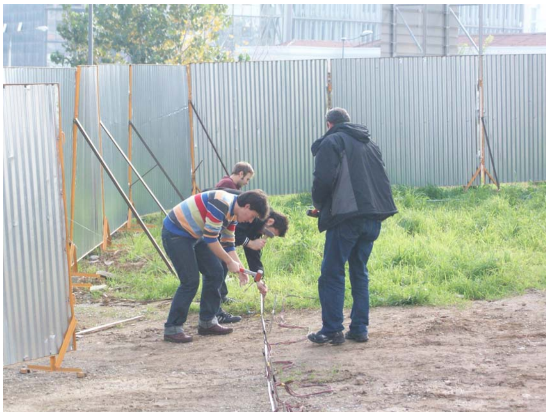
Εικόνα 32. Τοποθέτηση ηλεκτροδίων υπό τη καθοδήγηση του Αναπληρωτή Καθηγητή κ. Τσούρλου Παναγιώτη
