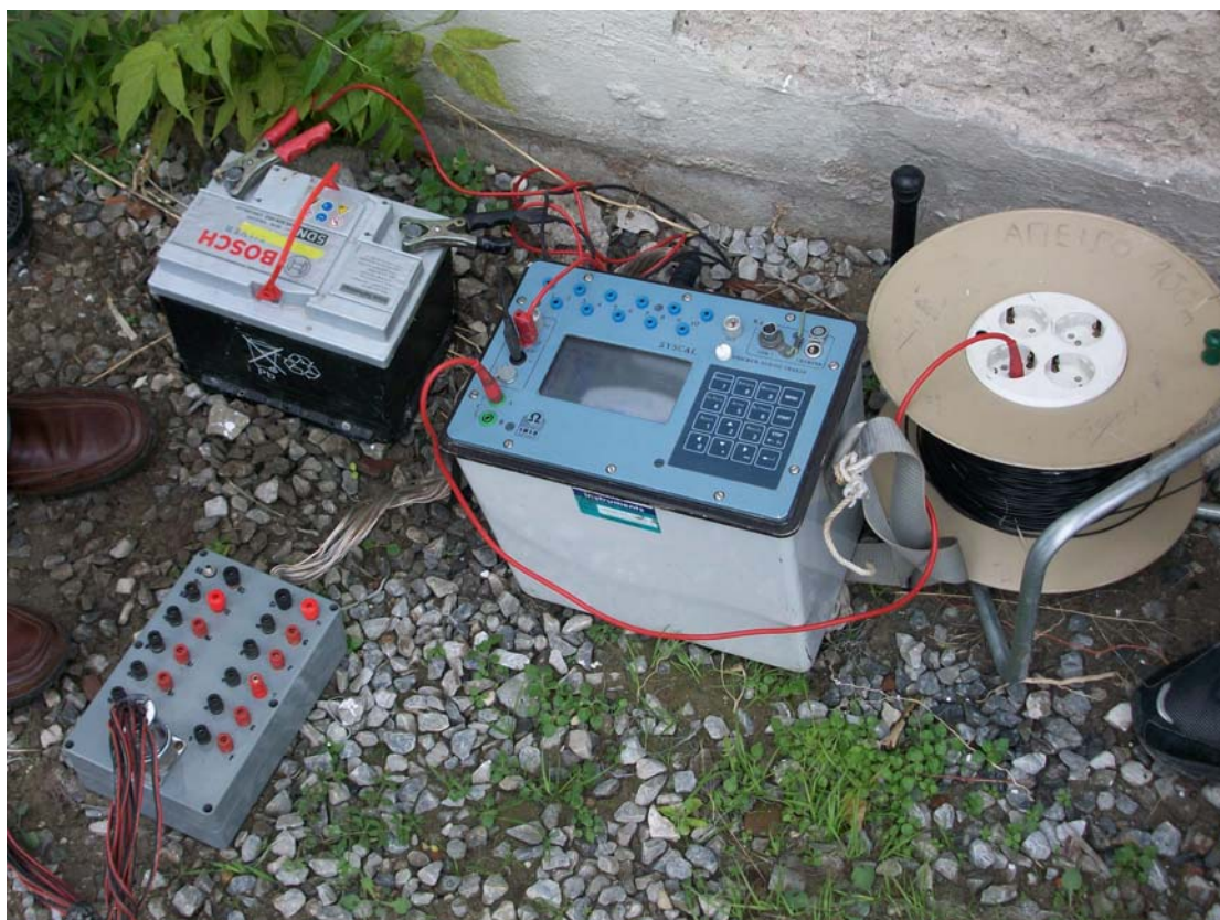
Εικόνα 23. Όργανο λήψης ηλεκτρικών μετρήσεων SYSCAL-PRO της εταιρείας IRIS INSTRUMENTS μαζί με τον πρόσθετο εξοπλισμό και τη συνδεσμολογία που χρησιμοποιήθηκε κατά τη διάρκεια της μέτρησης.
